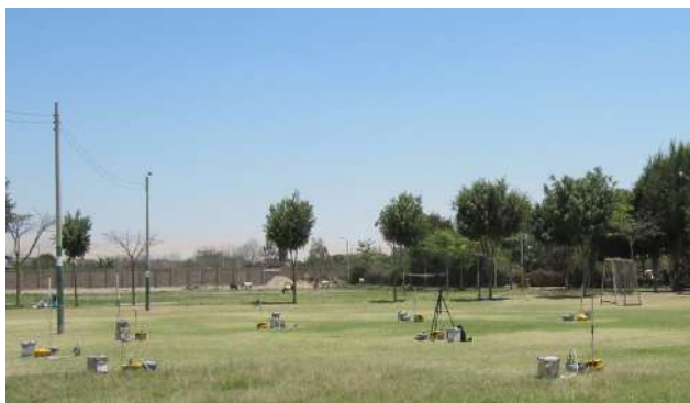
Arrays circulares en la ciudad de Ica para el registro de vibración ambiental y sísmica.
