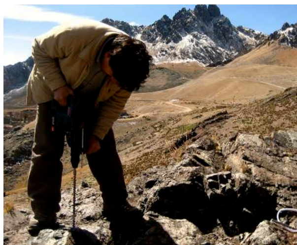
Instalación de un marcador para el monitoreo geodésico, en el marco del convenio con el IRD de Francia.
