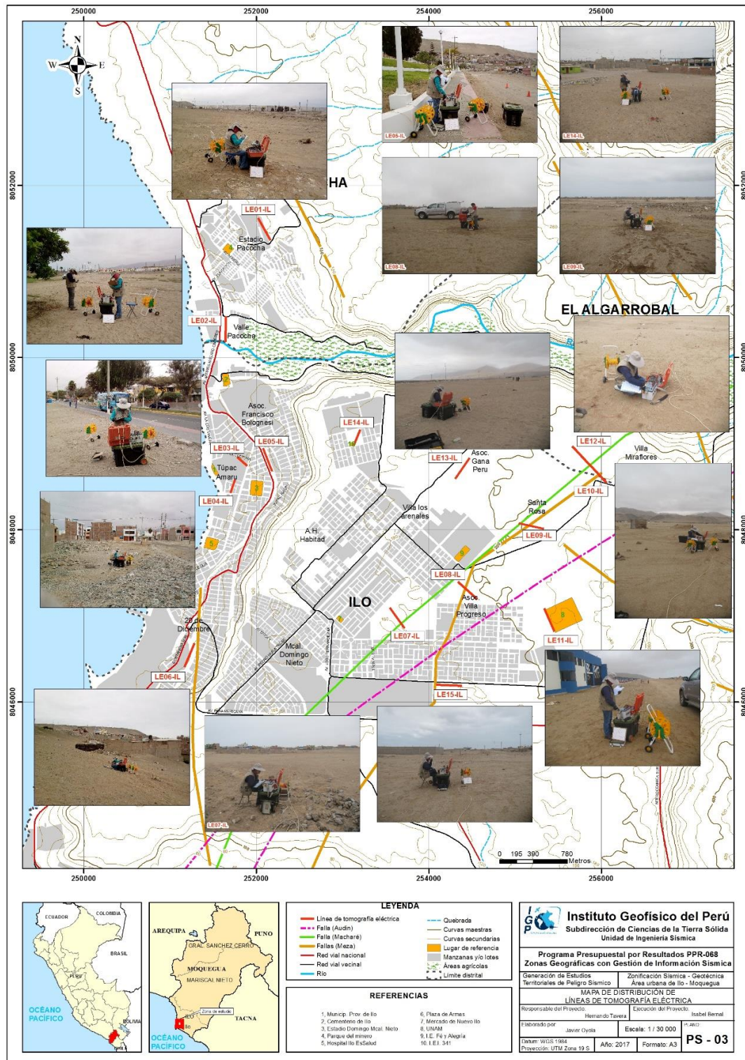
Figura 13: Mapa de las áreas urbanas de Ilo y Pampa Inalámbrica y la distribución espacial de las líneas de tomografía eléctrica codificadas como: LE01-IL, ..., LE15-IL.
