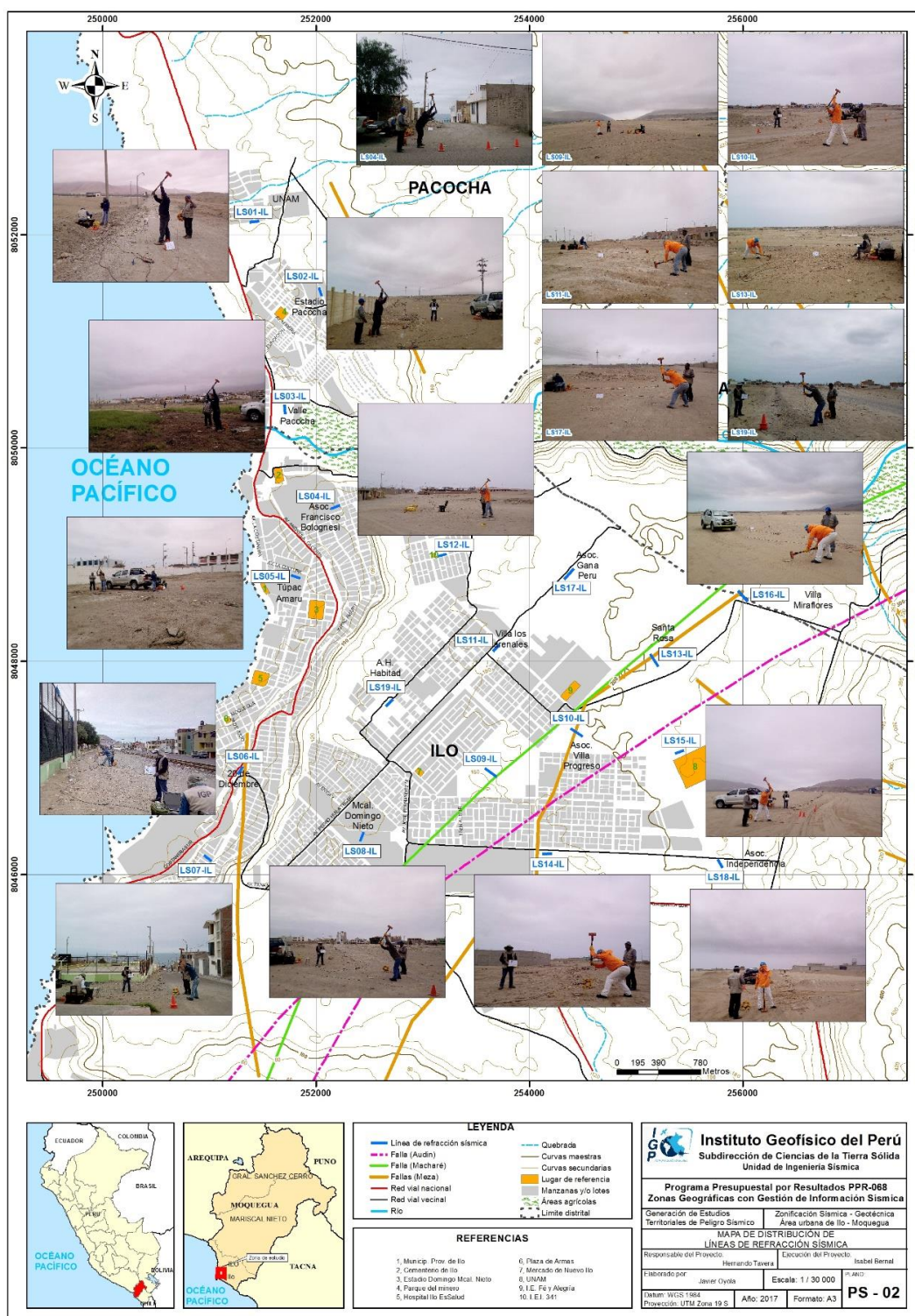
Figura 10: Mapa de las áreas urbanas de Ilo y Pampa Inalámbrica y distribución espacial de las líneas sísmicas codificadas como: LS01-IL, ..., LS19-IL.
