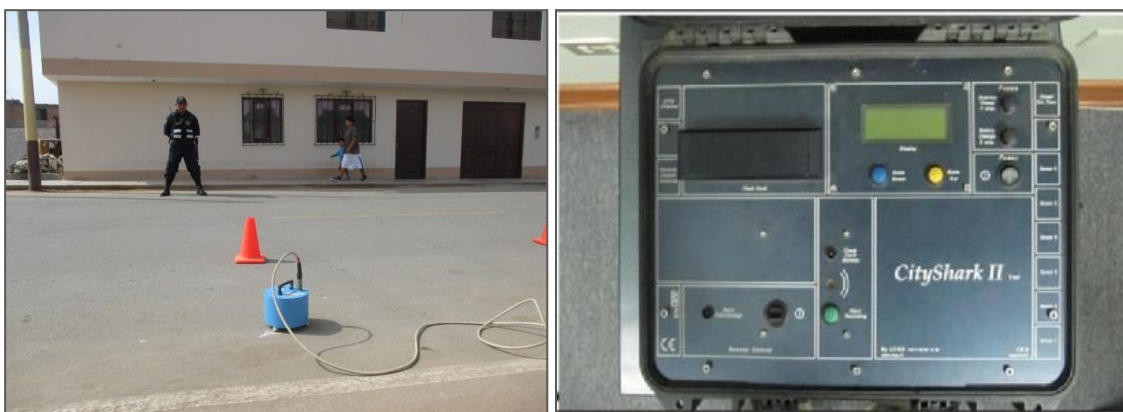
Figura 6: Equipo sísmico utilizado para el registro de vibraciones ambientales en Ilo y Pampa Inalámbrica: sensor Lennartz (2N) y registrador CityShark II.
