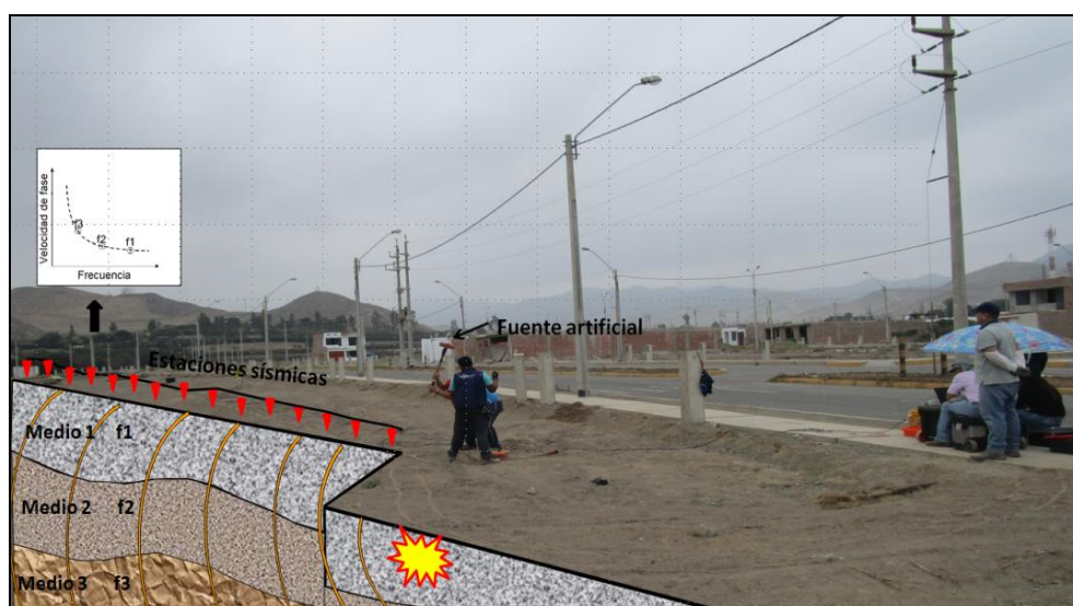
Figura 2: Generación de ondas Rayleigh con fuente artificial y su respectiva curva de dispersión.
