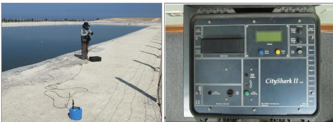
Figura 5: Equipo sísmico utilizado para el registro de vibraciones ambientales en San Clemente: sensores Lennartz (2N) y registrador CityShark II
