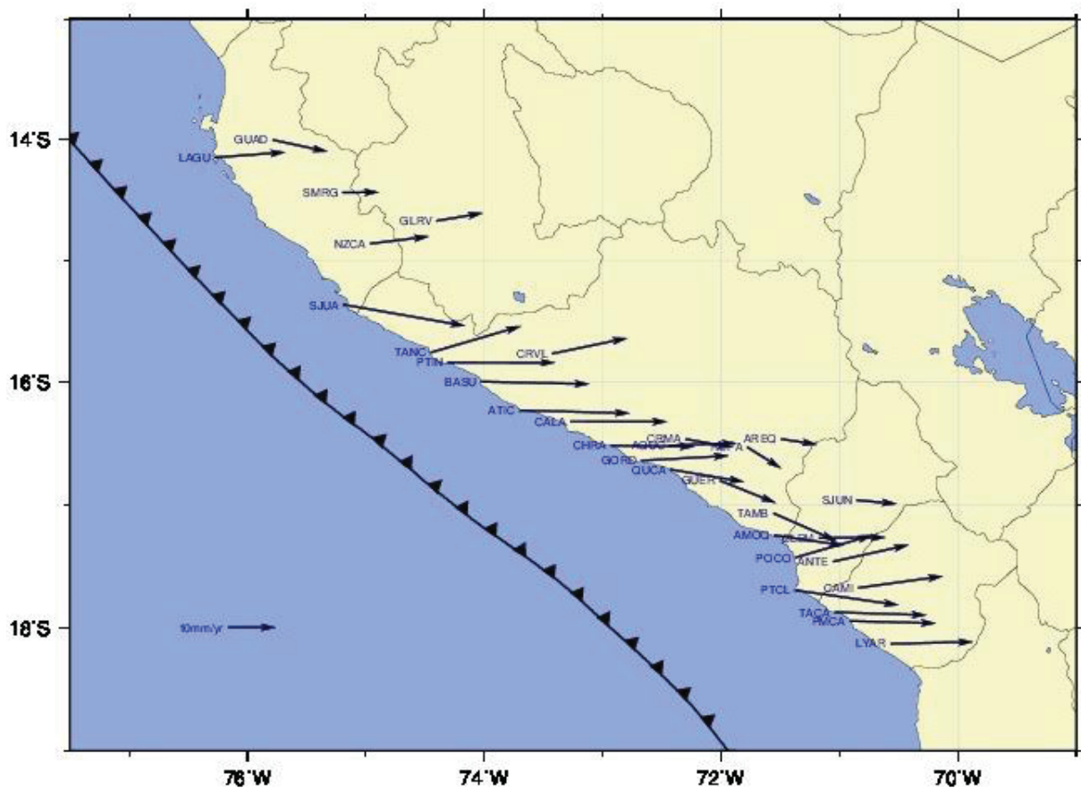
Figura 3. Velocidades GPS intersísmicas para el sur del Perú correspondientes al periodo 2012-2015 obtenidas por Quiroz (2016). Estas velocidades corresponden a puntos geodésicos de campaña y permanentes correspondientes a la red IGP-Isterre
