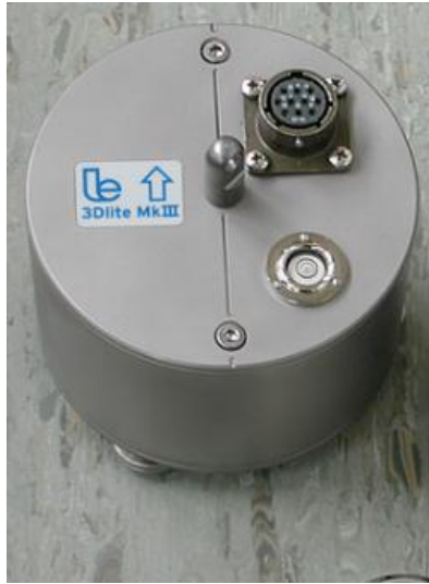
Figura 5.6 Sismómetro Lennartz LE-3D.
