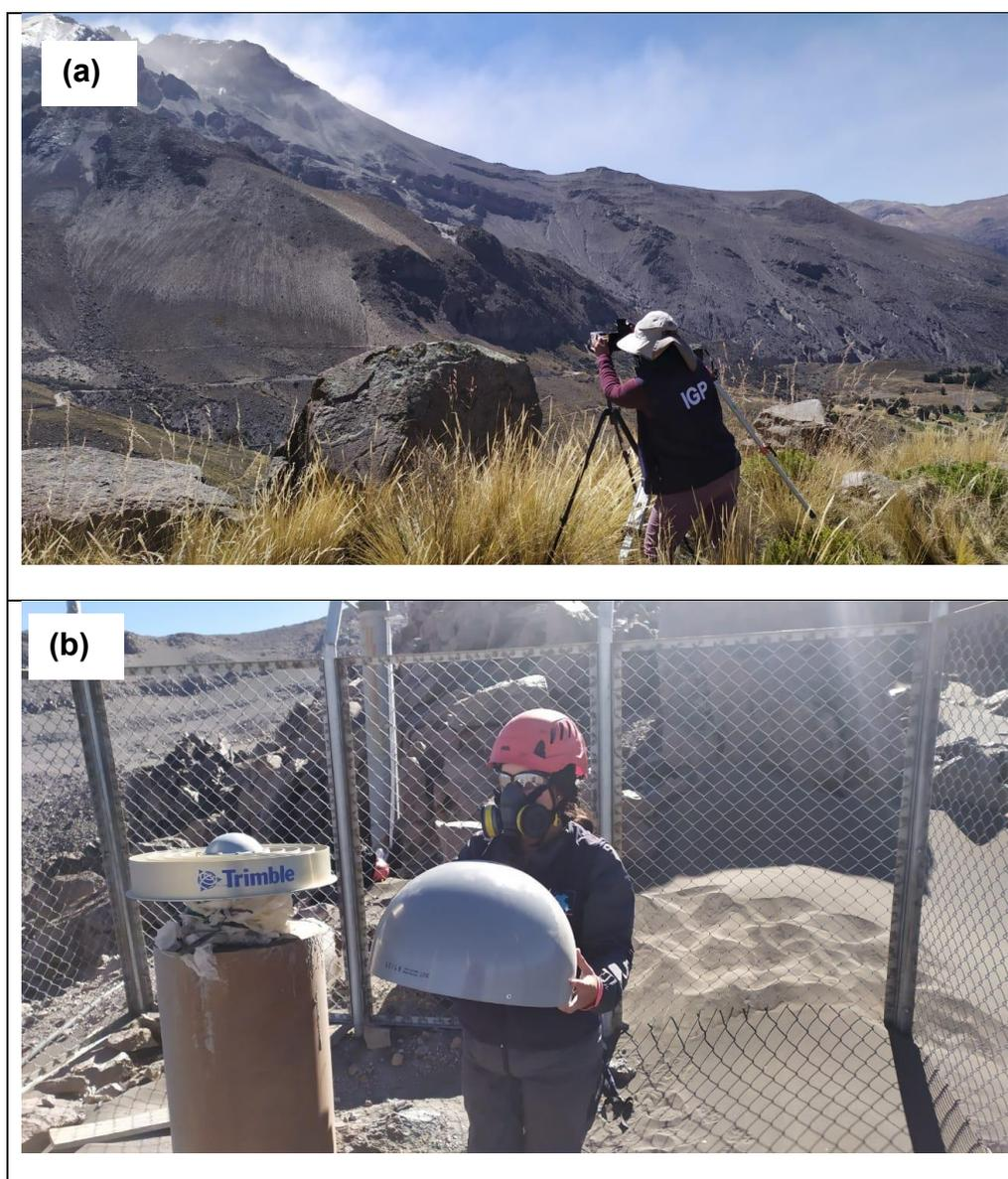
Figura 22.- (a) Adquisición de imágenes térmicas sobre el flanco sur del volcán Ubinas. (b) Entre el 25 y 26 de julio, el IGP ha realizado la instalación de 4 GPS adicionales en la zona del volcán Ubinas para reforzar el monitoreo realizado en dicho macizo
