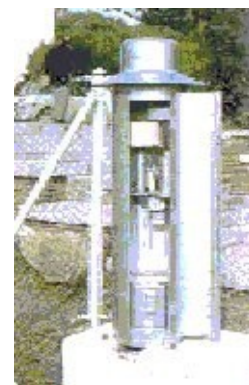
Figura 2. Pluviógrafo con sistema de reloj integrado
