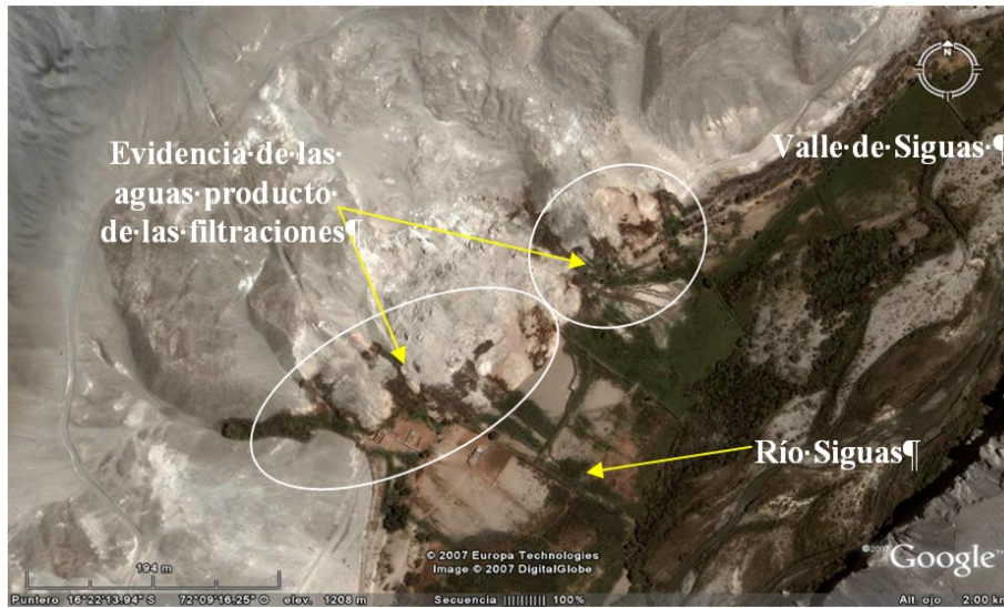
Figura 3. Vista satelital de las aguas producto de las filtraciones que se resumen en el curso del río Sigwas, valle de Sigwas, departamento de Arequipa.
