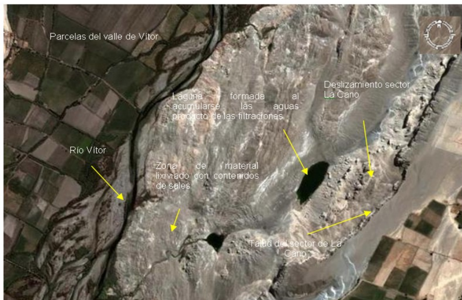
Figura 11. Laguna que se ha formado por las filtraciones en el sector La Cano, valle de Vítor .
