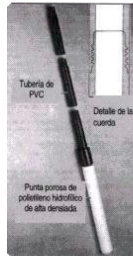
Figura 3. Piezómetro de tubo abierto tipo Casagrande con punta porosa plástica (Dunnicliff, 1993)
