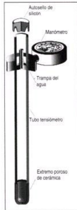
Figura 4. Elementos que componen un tensiómetro.
