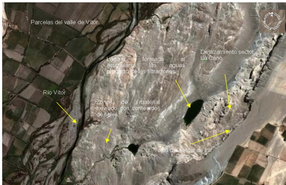
Figura 11. Laguna que se ha formado por las filtraciones en el sector La Cano, valle de Vitor .
