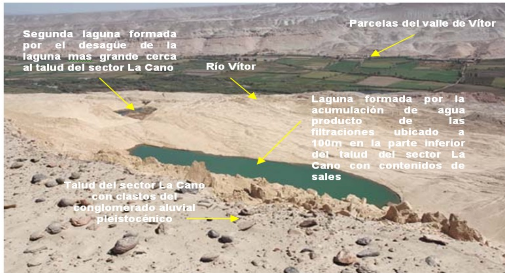
Figura 12. Laguna originada por las aguas resumidas producto de las filtraciones en el sector La Cano así como la pequeña laguna en el fondo izquierdo de la imagen.
