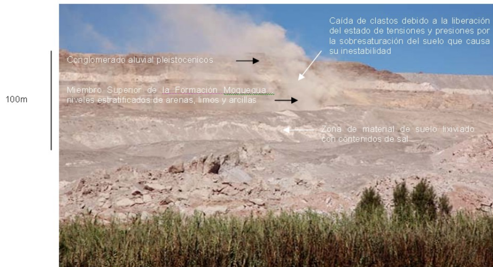
Figura 10. Deslizamiento del talud en el sector La Cano con sus respectivas unidades litológicas valle de Vitor (Flores N. y Maggiolo P. 1975)
