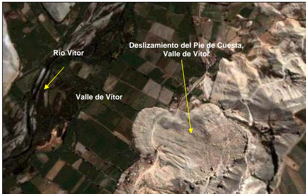
Imagen A. Vista aérea del deslizamiento de Pie de Cuesta, valle de Vitor, Arequipa.
