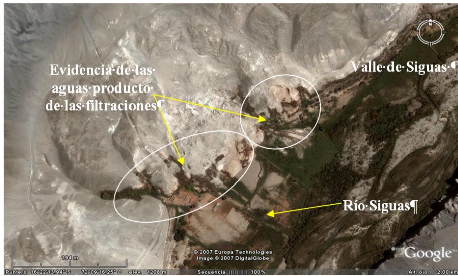
Figura 3. Vista satelital de las aguas producto de las filtraciones que se resumen en el curso del río Siguas, valle de Siguas, departamento de Arequipa.
