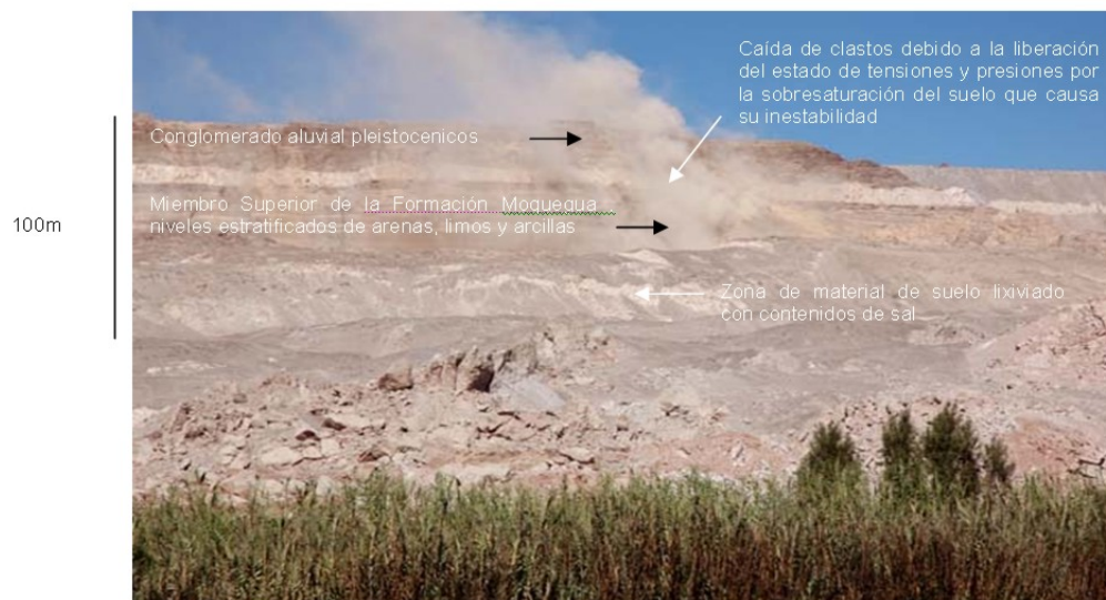
Figura 10. Deslizamiento del talud en el sector La Cano con sus respectivas unidades litológicas valle de Vítor (Flores N. y Maggiolo P. 1975)
