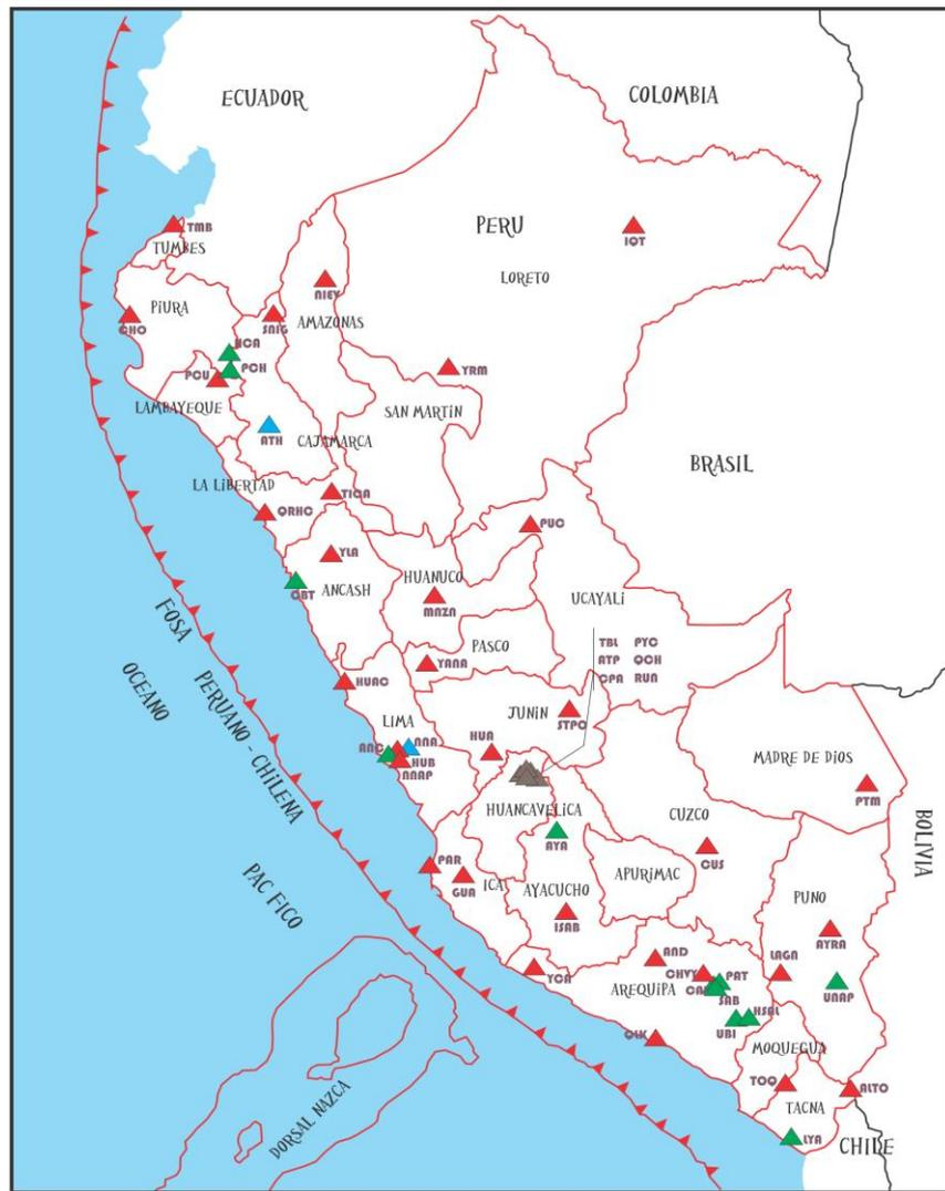
Figura 3.2. Distribución espacial de la red sísmica regional de Perú, perteneciente al Instituto Geofísico del Perú y compuesta por estaciones banda ancha y acceso satelital (triángulos en rojo), estaciones de banda ancha y acceso vía internet (triángulos en verde), estaciones de periodo corto (triángulos en marrón), y estaciones internacionales (triángulos en celeste).
