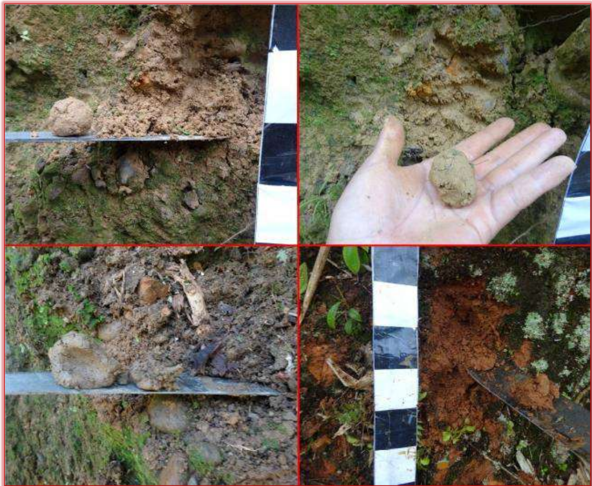
Figura 46. Ensayos de campo para estimar el porcentaje de arcilla en las terrazas
