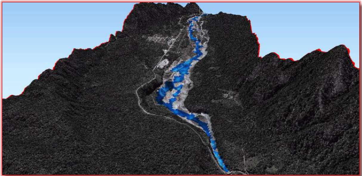
Figura 51. Simulación de un evento de flujo de agua con caudal de 24.1 \text{ m}^3/\text{s}
