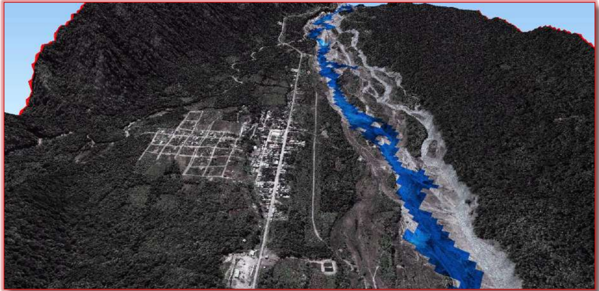
Figura 52. Vista ampliada del flujo de agua con un caudal de 24.1 \text{ m}^3/\text{s} en el centro poblado de Quincemil
