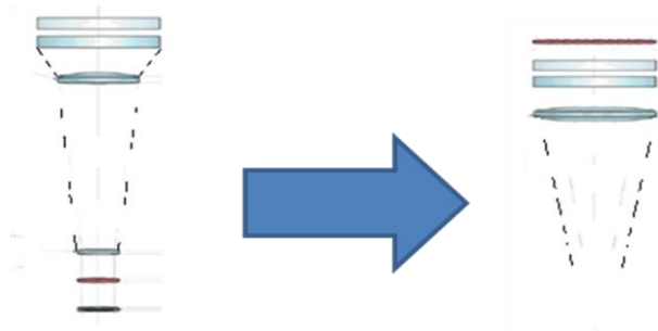
Figura 4. Actualizacion de sistema óptico de FPI
