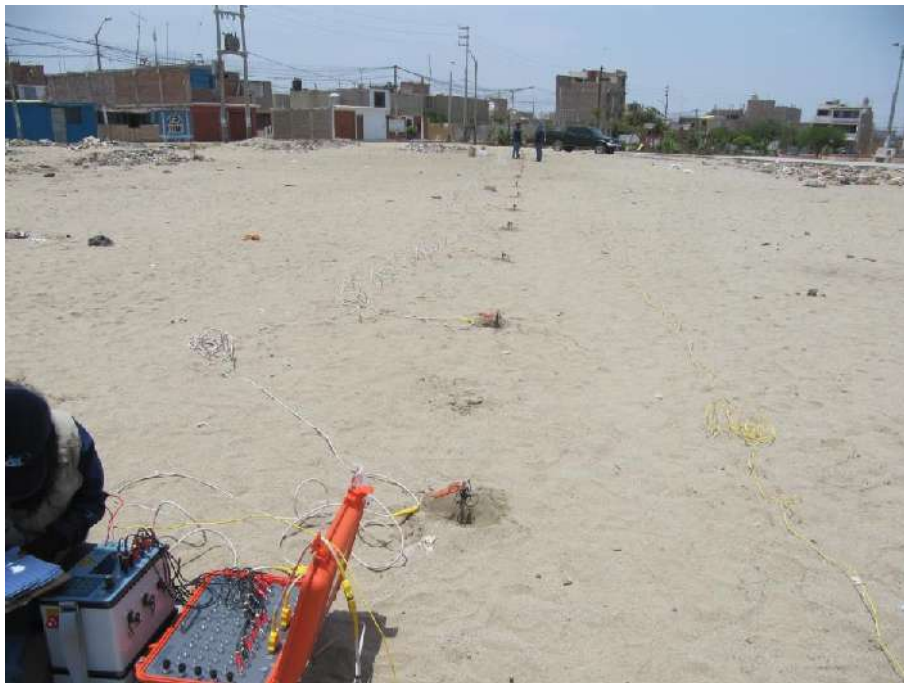
Figura 13: Disposición del equipo de prospección eléctrica para la toma de datos
