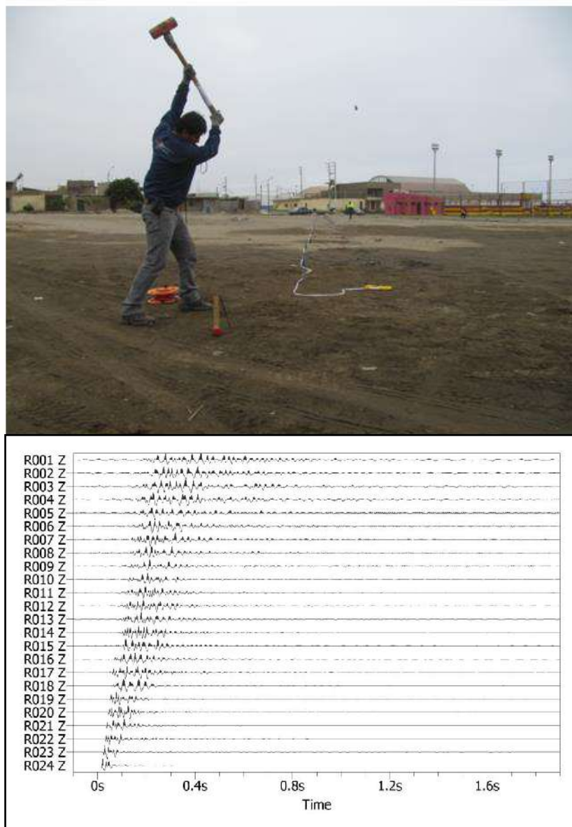
Figura 71: Disposición del equipo de refracción sísmica y registros obtenidos en la ciudad de Nuevo Chimbote
