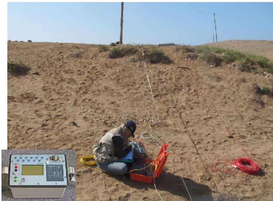
Figura9: Imagen de disposición del equipo de prospección eléctrica para la toma de datos en la ciudad de Chala
