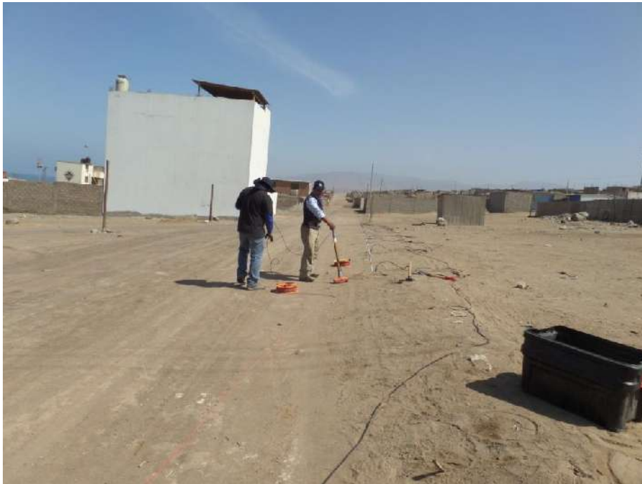
Figura 8: Imagen de la disposición del equipo de refracción sísmica en la ciudad de Chala
