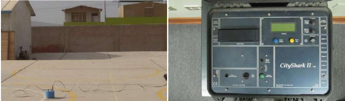
Figura 4: Equipo sísmico utilizado para el registro de vibraciones ambientales: sensores Lennartz (2N) y registrador CityShark
