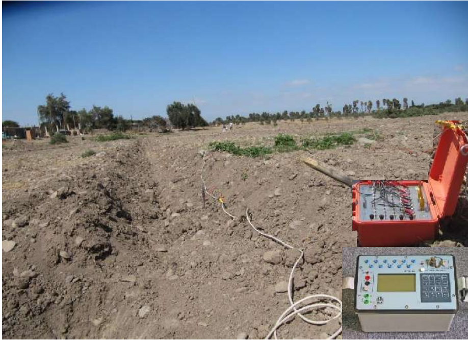
Figura 8: Imagen de disposición del equipo de prospección eléctrica para la toma de datos en la ciudad de Acarí
