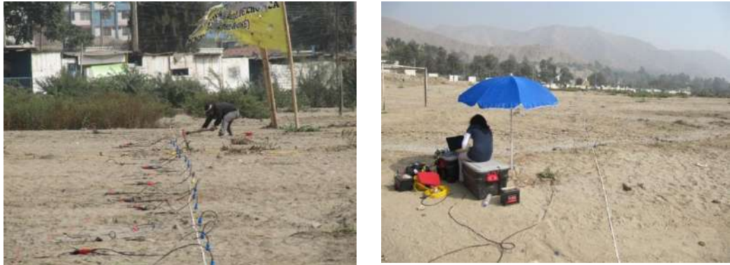
Figura 5.31. Imágenes de la disposición del tendido de refracción sísmica para la toma de data
