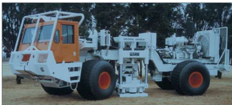
Figura 4.6 Camión vibrador servo-hidraulico M26HD/623B de Sercel.
