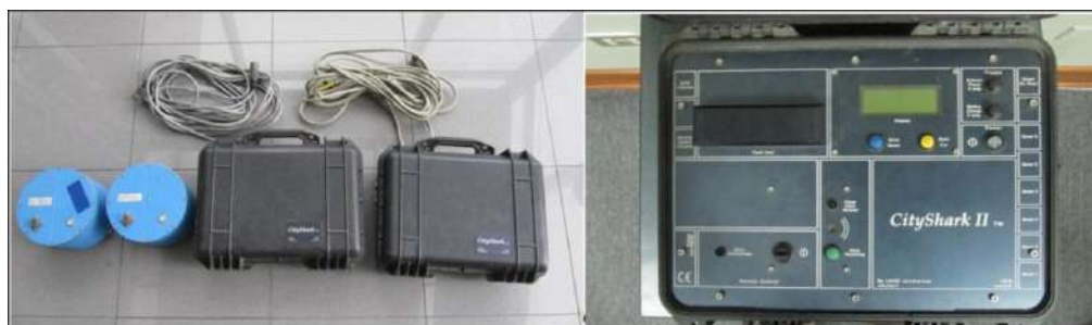
Figura 5.13. Equipo sísmico utilizado para el registro de ruido ambiental: sensores Lennartz (2N) y registrador CityShark.
