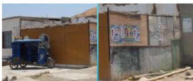
Figura 3.6: Inmueble expuesto ante eventos de tsunami, ubicado en la localidad de Puerto Huarney. Posee cobertura de techo de esteras y madera y las características físicas identificadas en su evaluación lo hacen altamente vulnerable ante eventos de tsunami.
