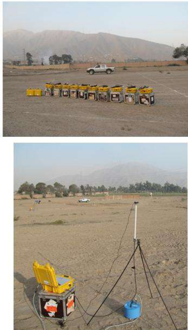
Figura 43: Imágenes de los arreglos sísmicos circulares realizados en Huaycan. Se muestran los equipos utilizados y su disposición a diferentes distancias radiales.
