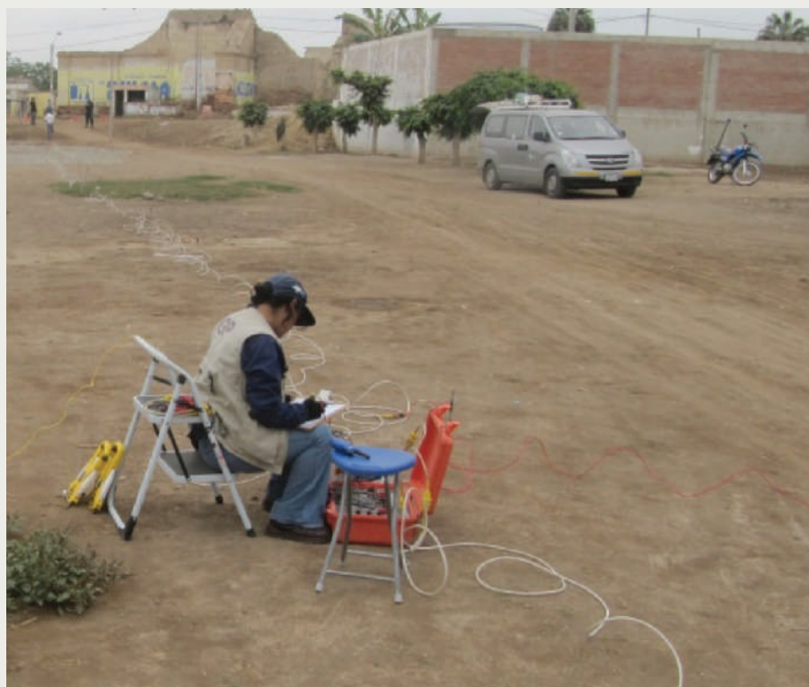
Imagen de disposición del equipo de prospección eléctrica para la toma de datos en la ciudad de Cañete.
