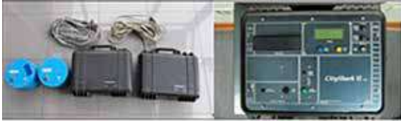
Figura 3. Equipo sísmico utilizado para el registro de vibración ambiental: sensores Lennartz (2N) y registrador CityShark.
