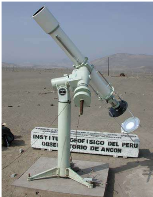
Figura 1. Telescopio Takahashi, proyectando la imagen del disco solar
