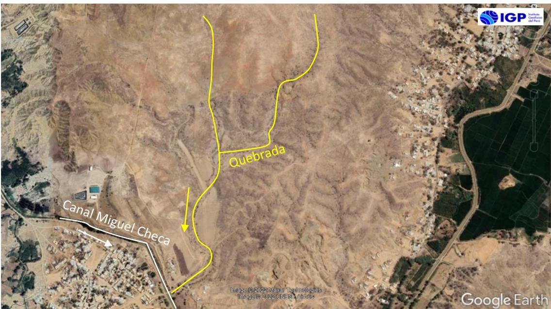
Figura 19. Zonas susceptibles a inundaciones fluviales han sido identificadas en las inmediaciones del cauce de una quebrada de cauce temporal (líneas amarillas) que se ubican en el extremo oriental de la plaza principal del C.P. La Golondrina.
