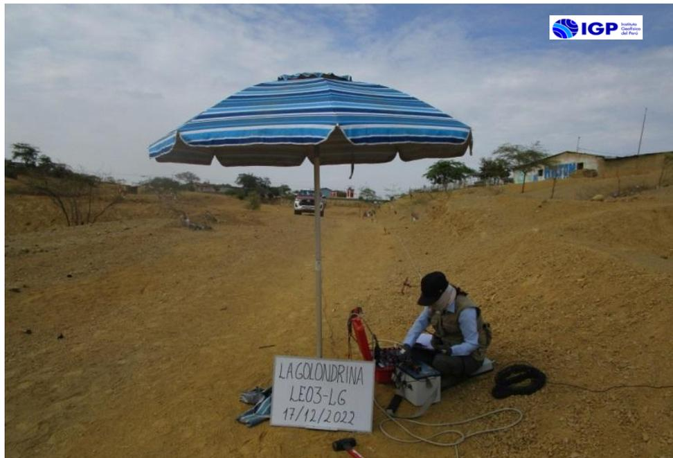
Figura 29. Disposición del equipo para la adquisición de datos de resistividad.
