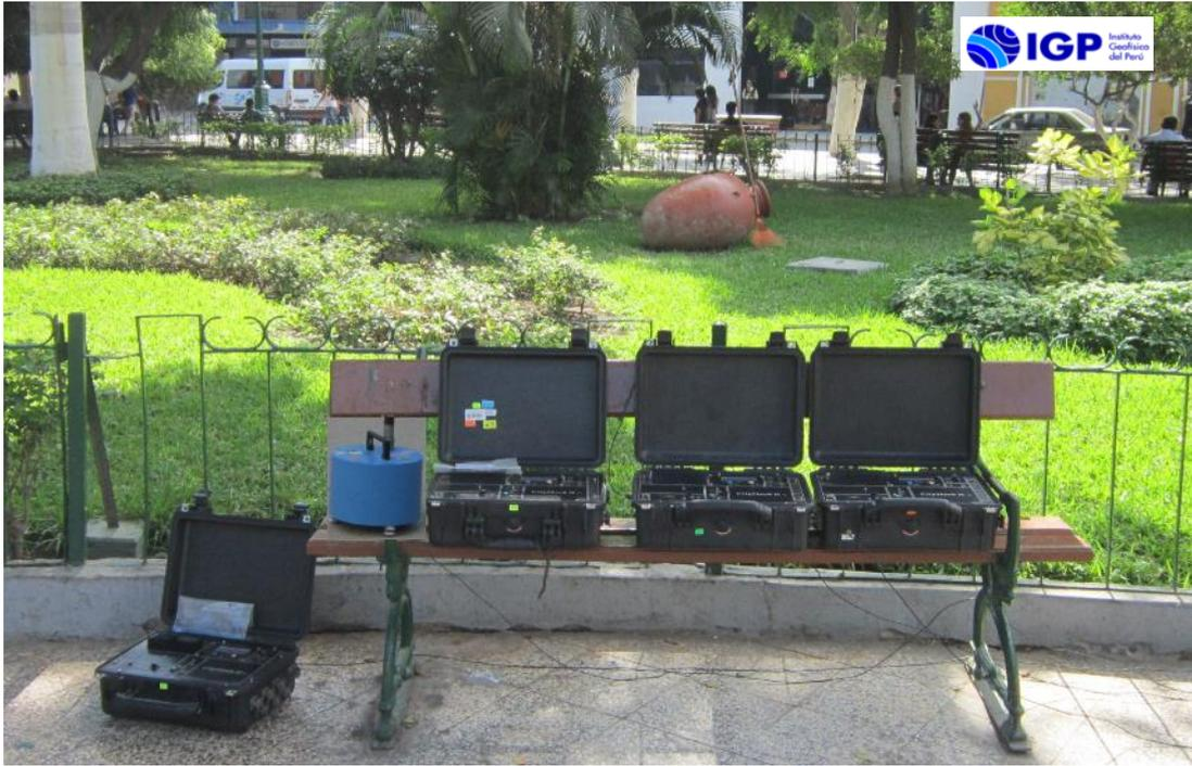
Figura 26. Equipo sísmico utilizado para el registro de vibraciones ambientales: sensor Lennartz (2N) y registradores CityShark II.
