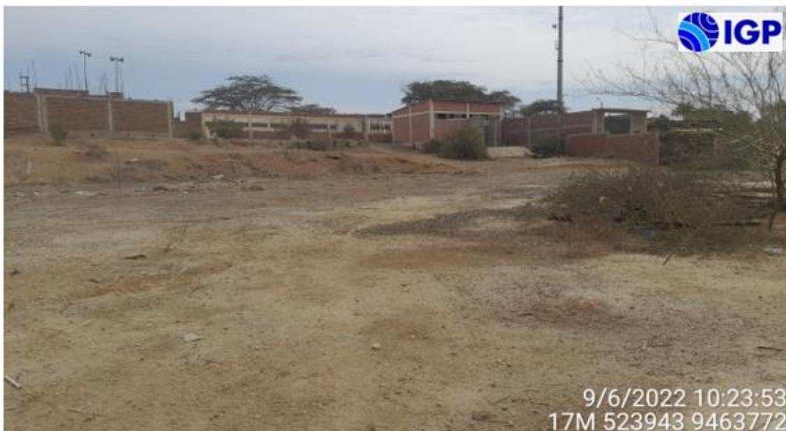
*Figura 3. Suelos heterogéneos dispuestos en la zona urbana del C.P. La Golondrina que conforma la unidad geológica depósito aluvial antiguo.*
