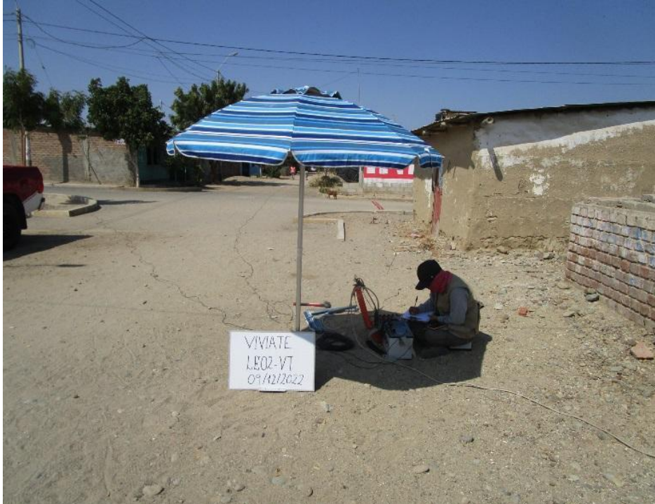
Figura 28. Disposición del equipo para la adquisición de datos de resistividad.
