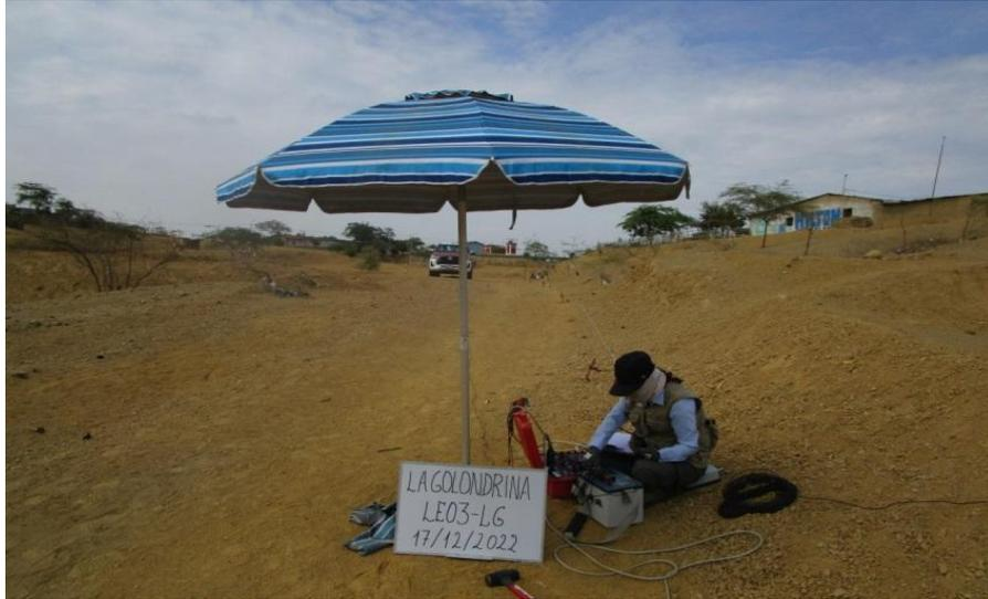
Figura 28. Disposición del equipo para la adquisición de datos de resistividad.
