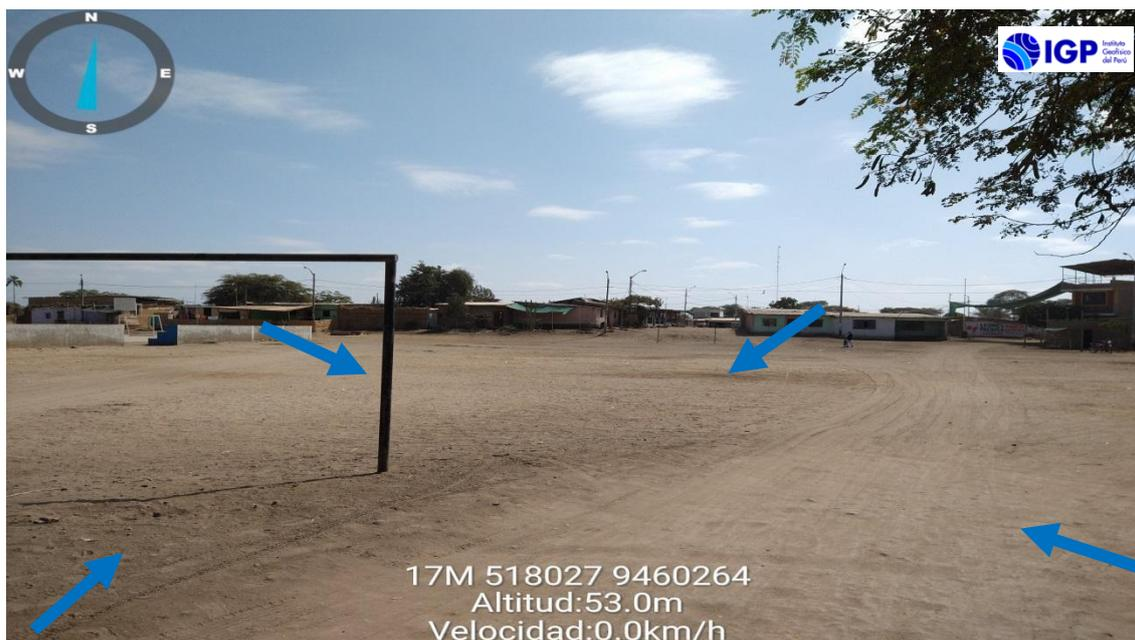
Figura 13. Áreas afectadas (flechas celestes) por inundaciones pluviales situadas en la cancha El Salitre que se encuentra en zona de baja pendiente. Zona de acumulación de aguas de las calles principales, las flechas indican la dirección del flujo.
