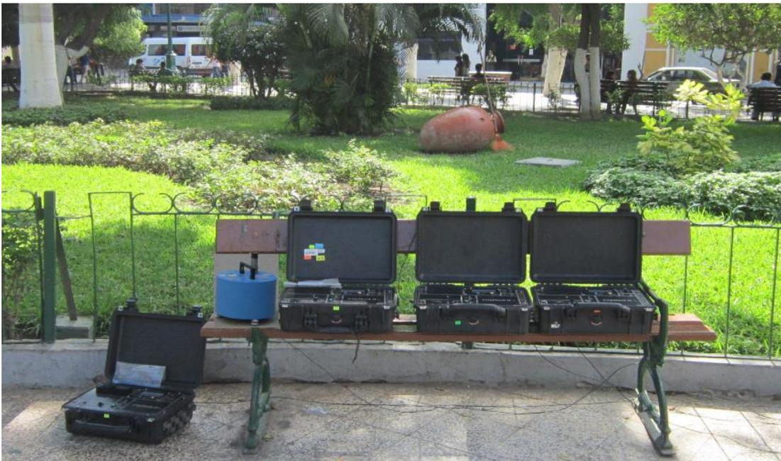
Figura 21. Equipo sísmico utilizado para el registro de vibraciones ambientales: sensor Lennartz (2N) y registradores CityShark II.
