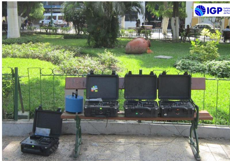
Figura 24. Equipo sísmico utilizado para el registro de vibraciones ambientales: sensor Lennartz (2N) y registradores CityShark II.
