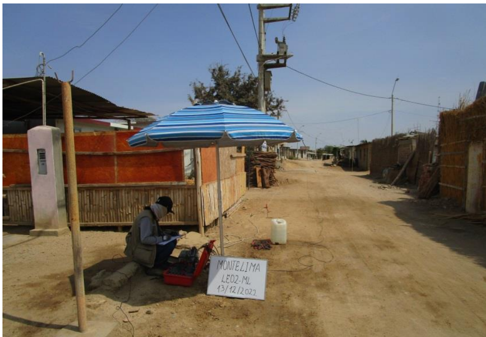
Figura 25. Disposición del equipo para la adquisición de datos de resistividad.
