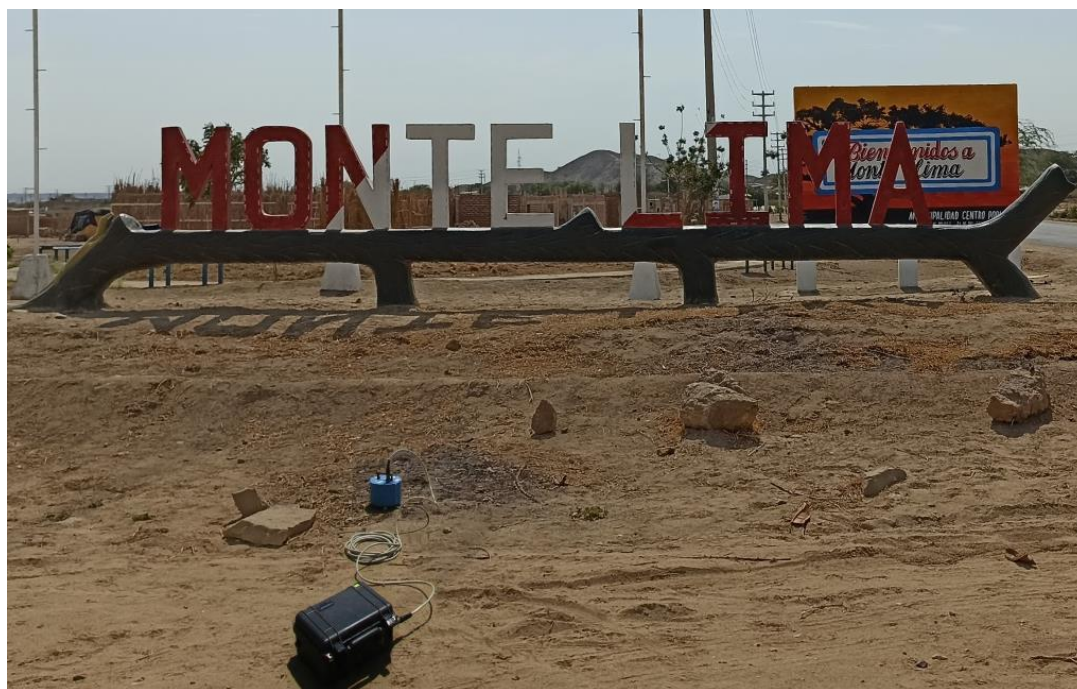
Figura 22. Equipo sísmico utilizado para el registro de vibraciones ambientales: sensor Lennartz (2N) y registradores CityShark II.
