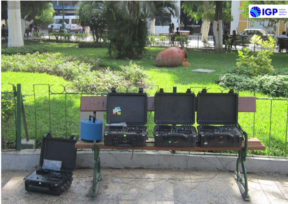
Figura 25. Equipo sísmico utilizado para el registro de vibraciones ambientales: sensor Lennartz (2N) y registradores CityShark II.
