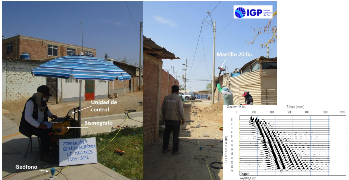
Figura 27. Disposición del equipo para la adquisición de registros sísmicos – MASW.
