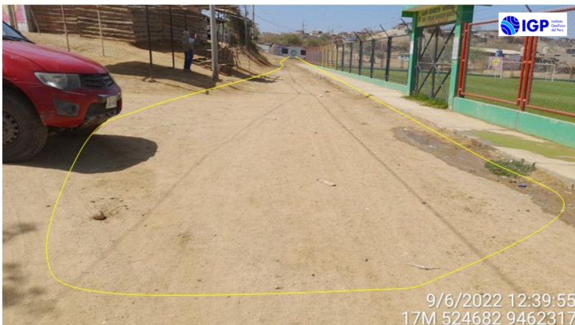
Figura 17. Zona susceptible a la ocurrencia de inundaciones pluviales (polígono amarillo) ubicada en las inmediaciones del centro deportivo La Victoria, cuyas aguas de escorrentía provienen por las calles situadas en el extremo nororiental de la infraestructura.
