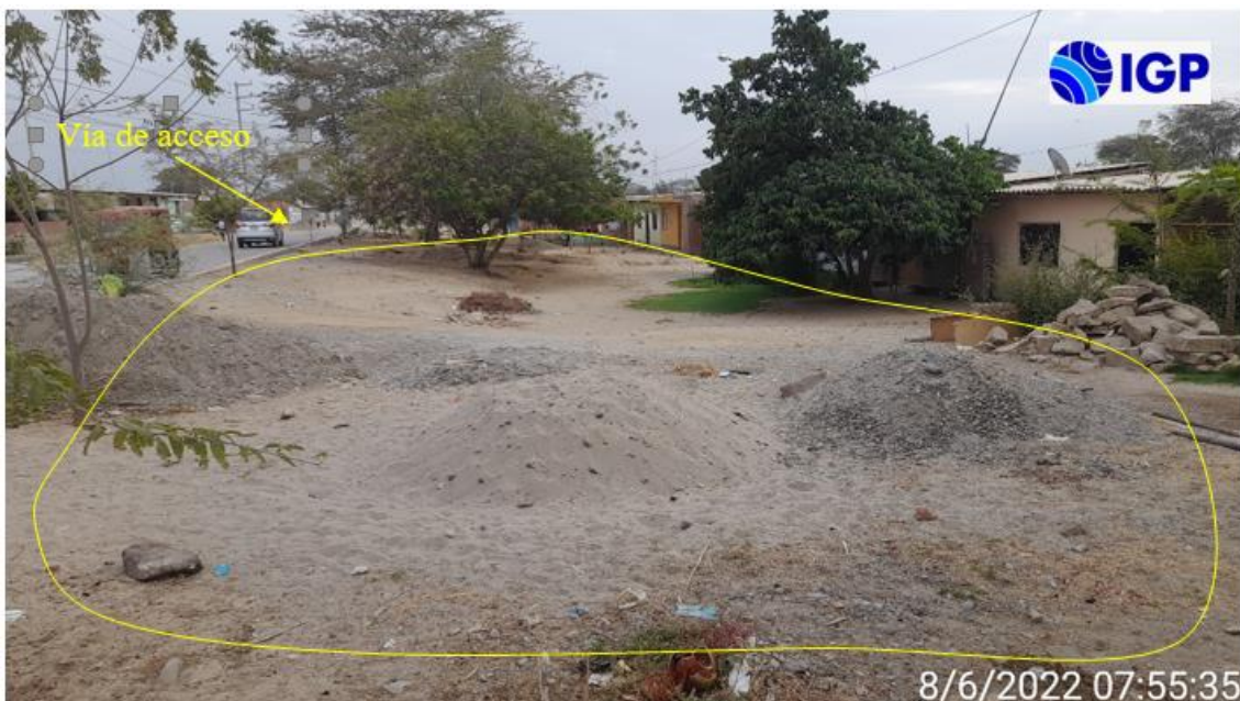
Figura 17.- Zona susceptible a inundaciones pluviales (polígono amarillo) ha sido identificada en la vía asfaltada que se sitúa a 30 m al norte del parque El Caballito, cabe señalar que, ocupa una depresión aluvial que presenta desnivel topográfico inferior de 1.0 m respecto a la vía de acceso.
