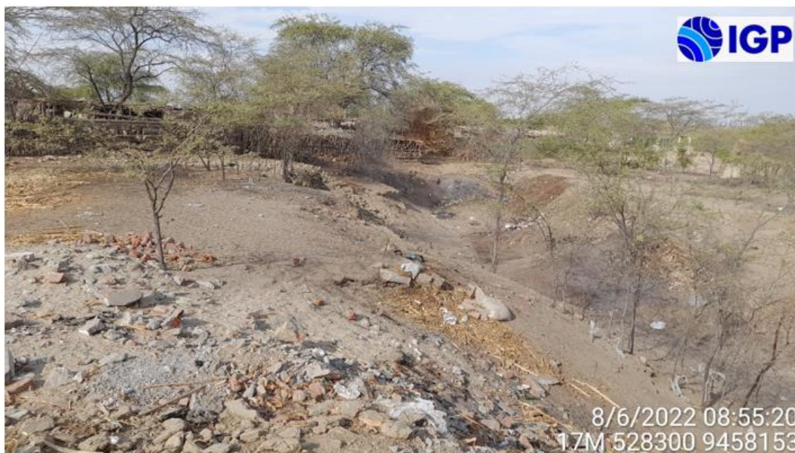
Figura 19.- Erosión de laderas en el extremo norte del poblado del C.P. Jíbito, generado por la presencia de escorrentías superficiales durante el periodo de lluvias intensas
