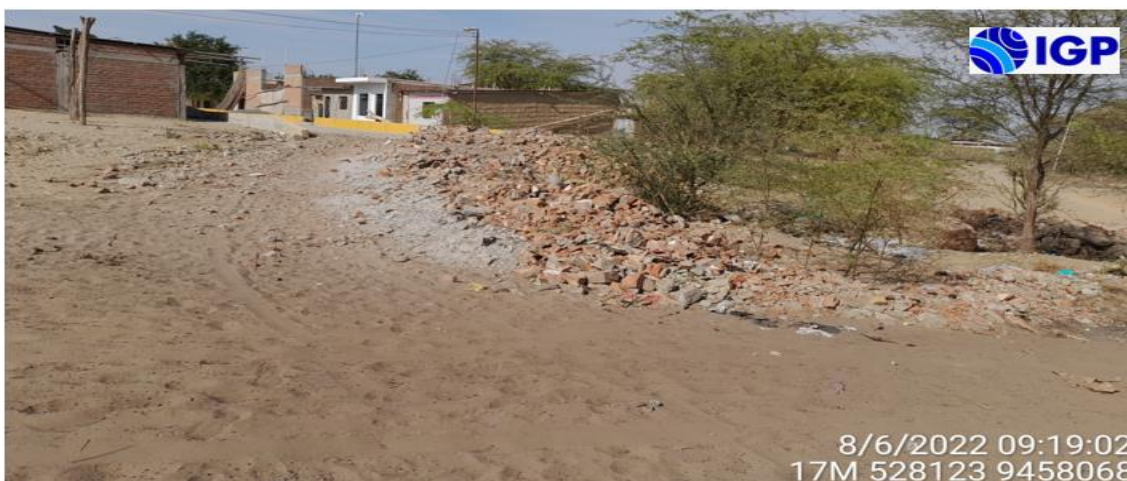
Figura 6.- Depósito antrópico dispuesto en el extremo norte del C.P. Jíbito, consiste en materiales generados por actividades inducidas por acción humana
