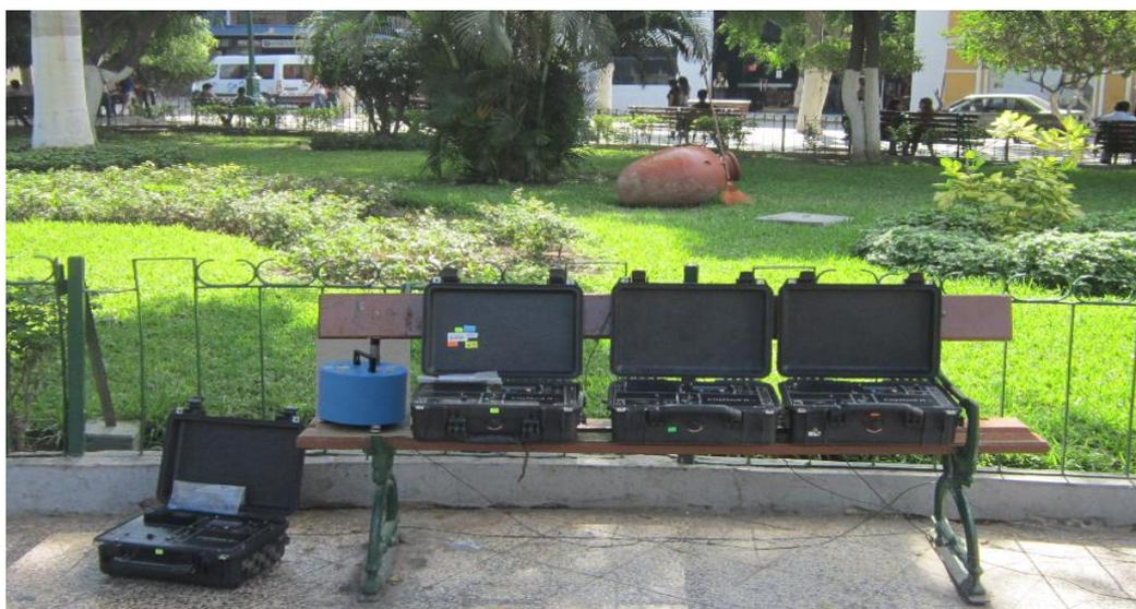
*Figura 24. Equipo sísmico utilizado para el registro de vibraciones ambientales: sensor Lennartz (2N) y registradores CityShark II.*
