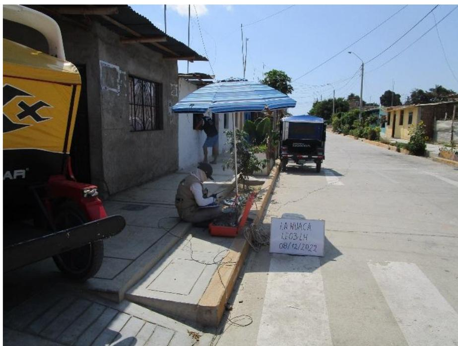
*Figura 27. Disposición del equipo para la adquisición de datos de resistividad.*
