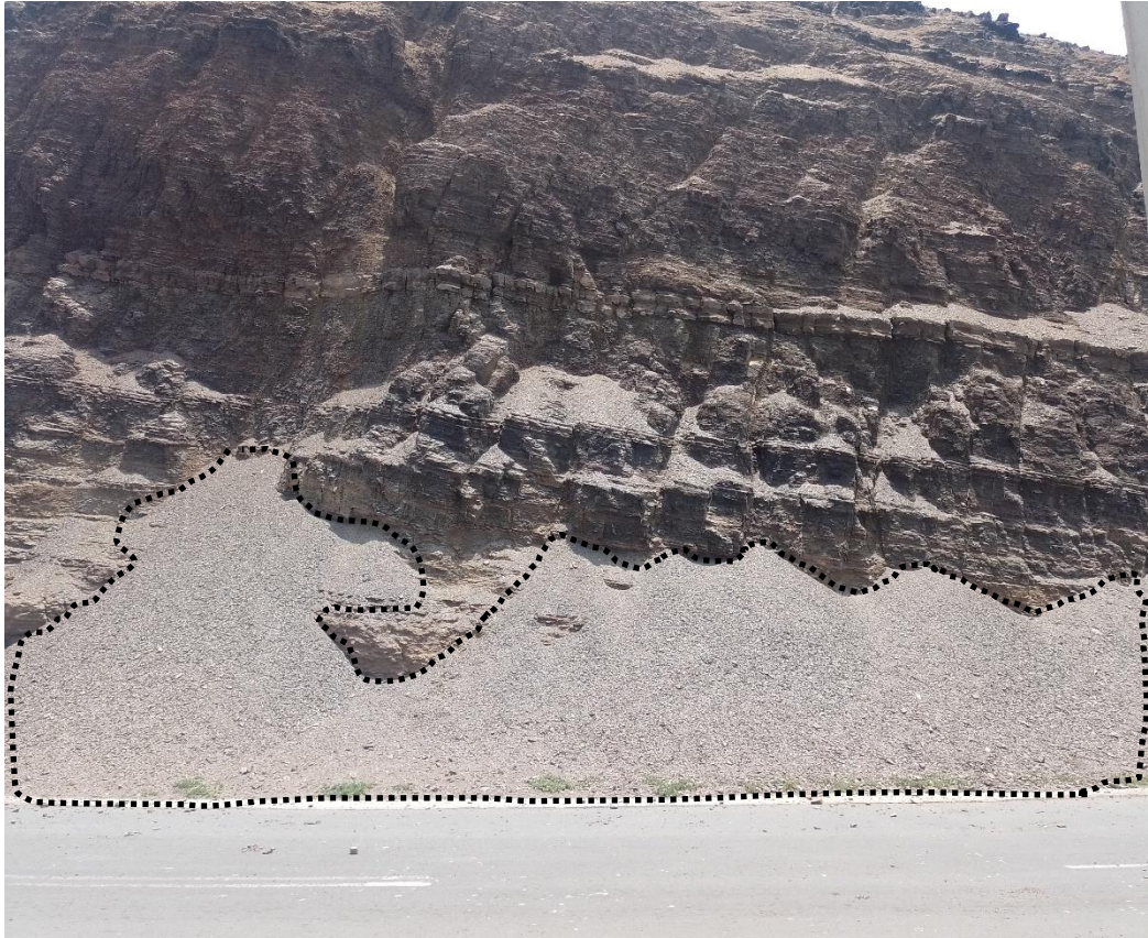
Figura 7.- Depósitos deluviales en forma de conos ubicados en el pie del acantilado en el acceso salida boulevard Herradura.
