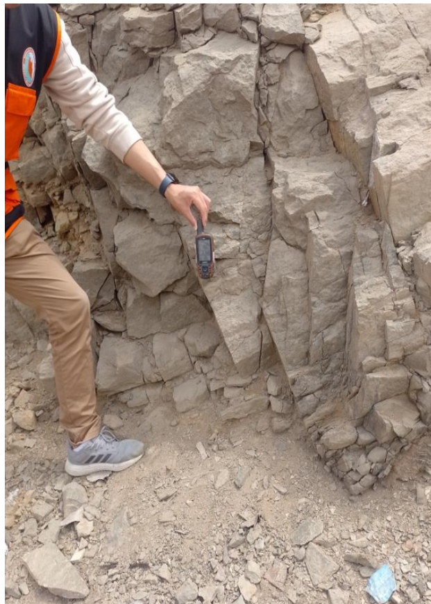
Figura 5. Areniscas de grano fino a medio de la formación La Herradura, ubicado en el acceso al túnel.
