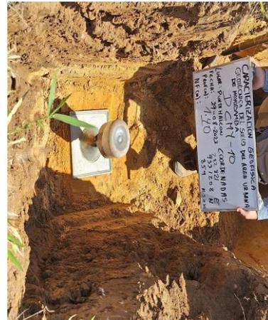
En la calicata 10 se realizó ensayo de densidad natural, a través del método del cono de arena.
