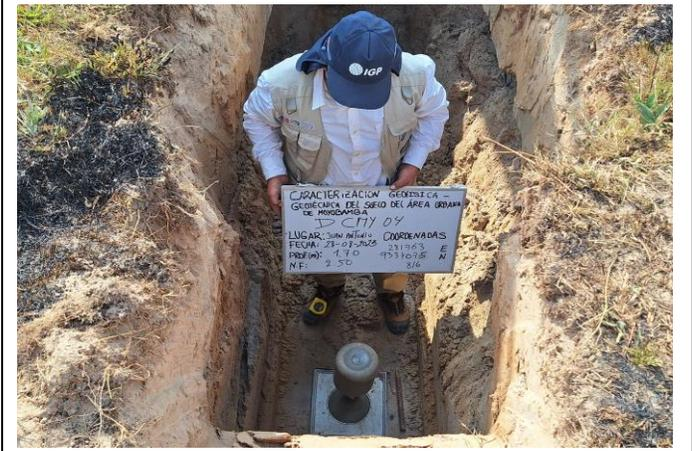
En la calicata 04 se realizó ensayo de densidad natural, a través del método del cono de arena.
