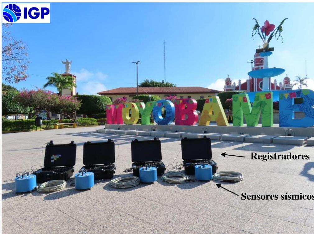
Figura 28. Equipo sísmico utilizado para el registro de vibraciones ambientales: sensor Lennartz (2N) y registradores CityShark II.
