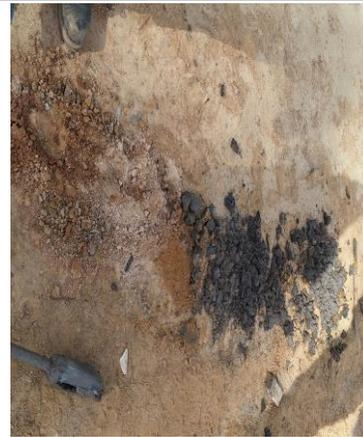
En el posteo 12 predominan material de relleno de tipo arenas y arcillas, seguido de turba a 1.70 m, seguida de arenas sueltas como terreno natural.
