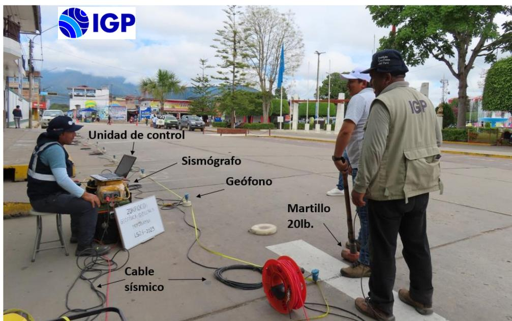
Figura 35. Equipos utilizados en la adquisición de datos MASW – MAM, en la plaza de Armas de Moyobamba.
