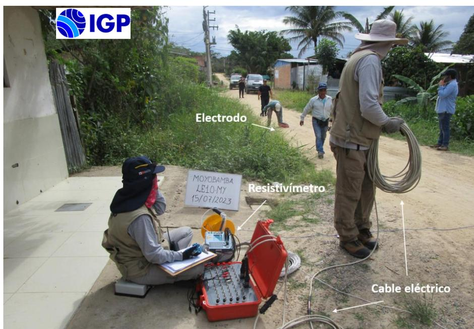
Figura 40. Equipos utilizados en la adquisición de datos ERT.
