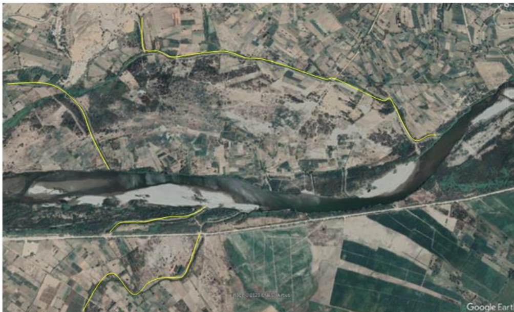
Figura 54.- Depósito aluvial reciente que consiste en materiales heterogéneos (arenas y limos) dispuestos sobre el cauce y canales de regadío
