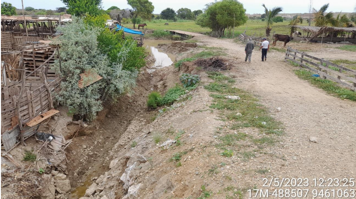
Figura 48.- Depósito aluvial reciente conformado por materiales heterogéneos (principalmente arenas y limos) sobre el que se asientan las viviendas de Miramar
