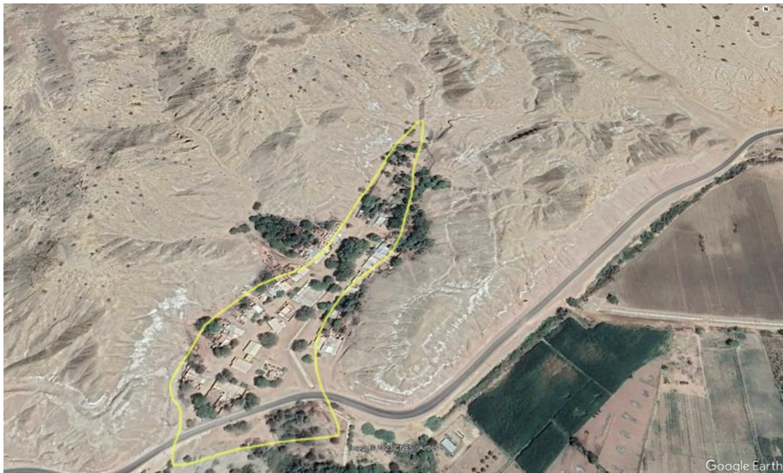
Figura 33.- Depósito aluvional (polígono amarillo) formado durante la activación de quebradas que consiste en materiales de composición heterogénea.
