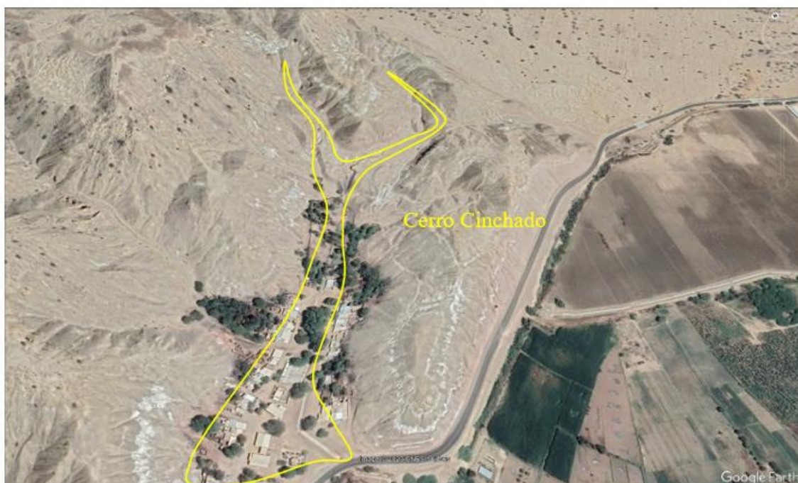
Figura 59.- Zona susceptible a flujos de lodo (polígono amarillo) ha sido reconocida en las inmediaciones del poblado La Soledad
