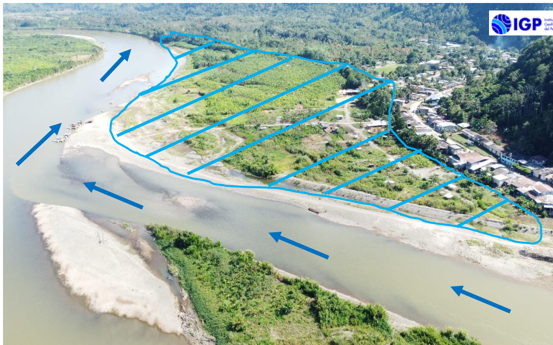
Figura 15.- Inundaciones fluviales generadas por el desborde del río Huallaga, margen derecha, afectando las viviendas que se asientan en la llanura aluvial, de acuerdo al testimonio de los pobladores se delimitó el área inundable (contorno celeste)
