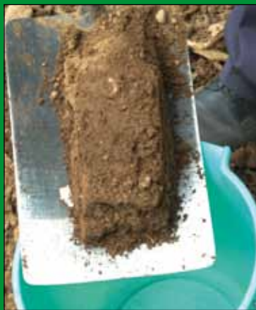
Figura 10. Homogenización de las submuestras. Se obtienen al mezclar todas las muestras.
