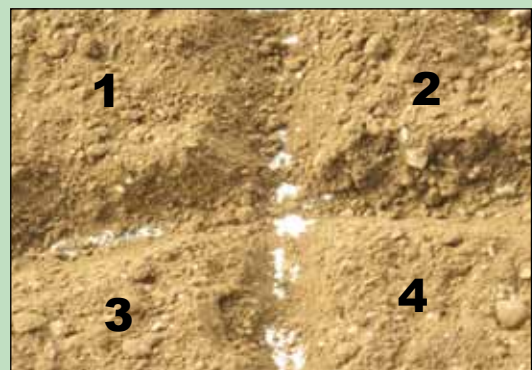
Figura 13. El "cuarteo" hecho en la mantada para tomar la muestra a ser analizada.
