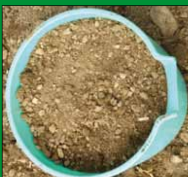
Figura 10. Homogenización de las submuestras. Se obtienen al mezclar todas las muestras.
