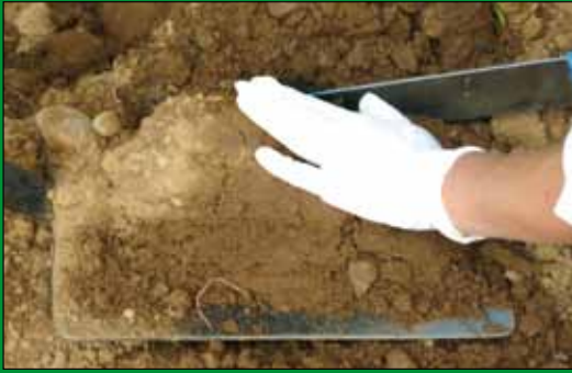
Figura 7. Con un cuchillo o machete se retira ambos bordes laterales de la submuestra tomada con la pala, hasta dejar en su parte central una porción de aproximadamente 5 cm de ancho.
