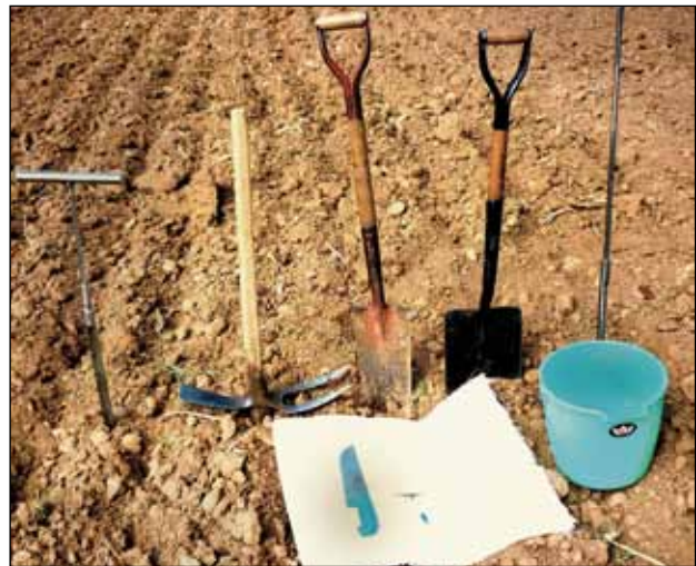
Figura 2. Principales materiales usados para el muestreo del suelo.
