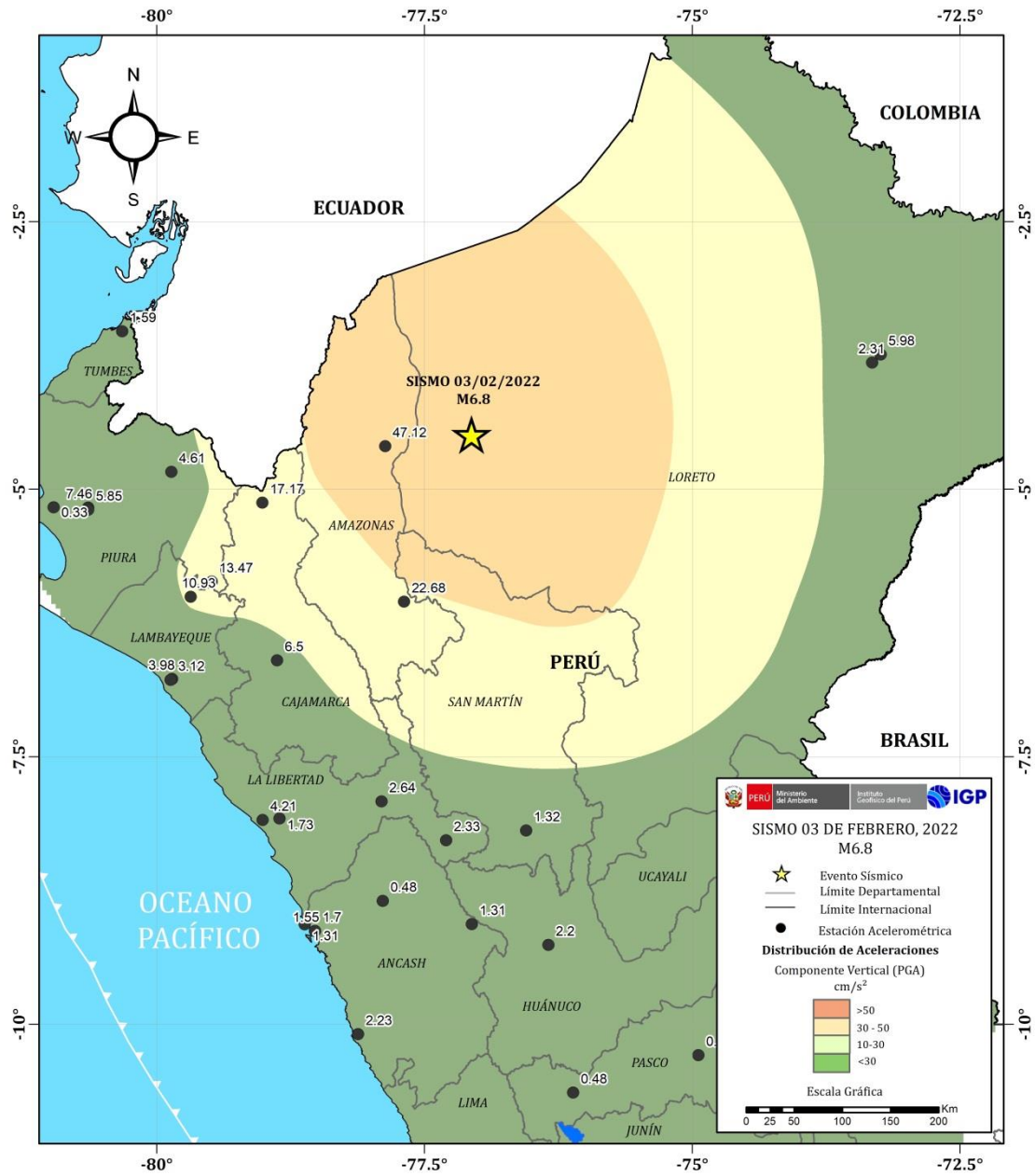
Figura 6c: Aceleraciones del suelo registradas en la componente vertical (Z) debido al sismo de Barranca - Datem del Maraón del 03 de febrero 2022 (M6.8)
