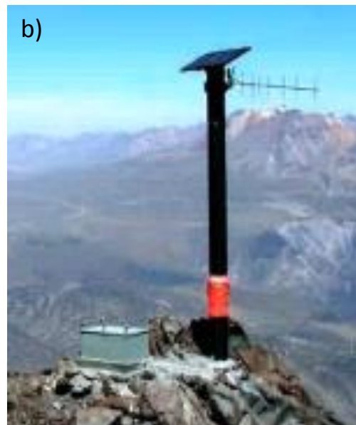
Figura 5.1.- Red sísmica telemétrica permanente de monitoreo sobre el volcán Misti.
