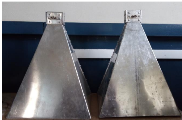
Fig. 4.3: Antenas implementadas en el ROJ (Fuente: el autor)
