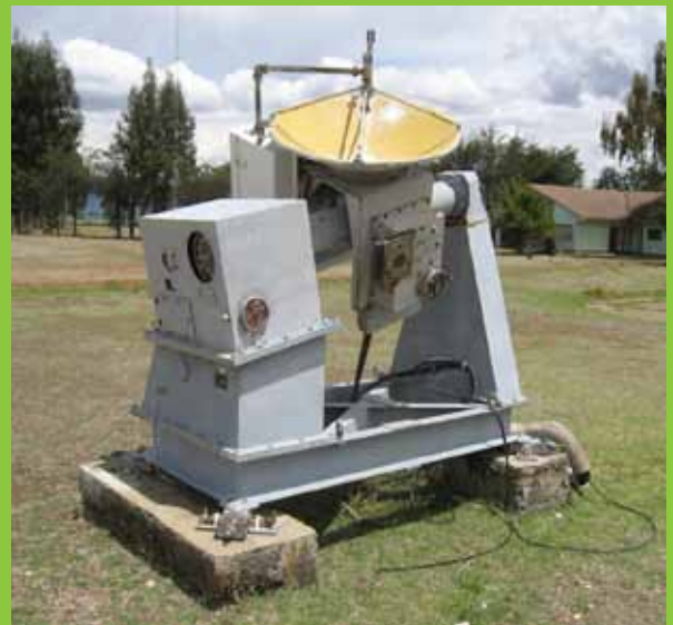
Figura 1. Radio polarímetro a 9,4 GHz del Observatorio "John A. Fleming" de Huancayo, IGP.
