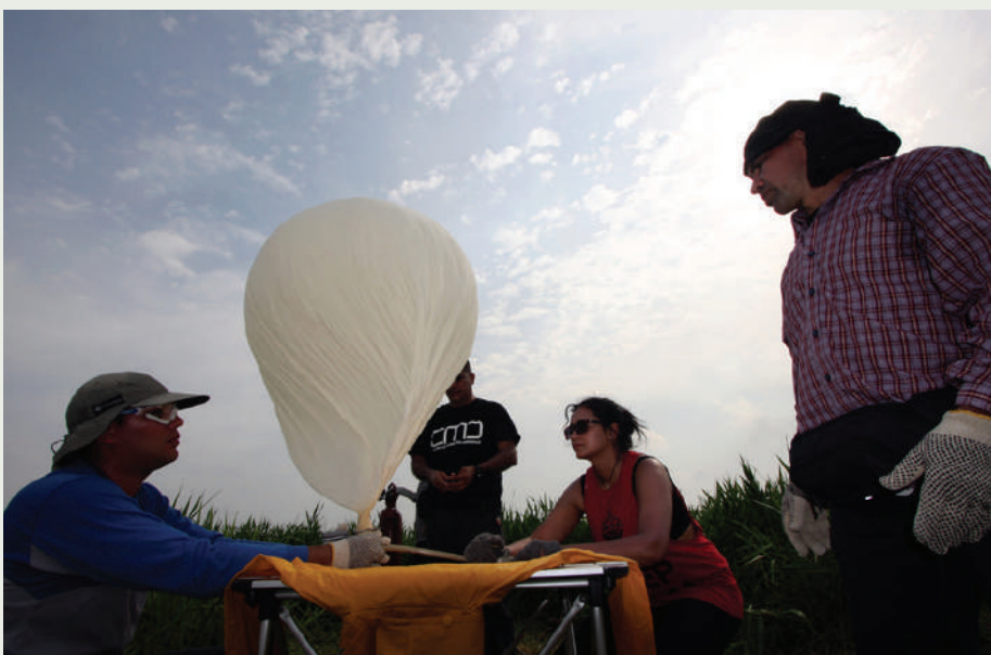
Figura 3. Lanzamiento en Catatumbo de globos cautivos de neopreno con sensores meteorológicos iCaro, diseñados y manufacturados por el Centro de Modelado Científico de Universidad del Zulia. Crédito: Hernán Parra – CMC
