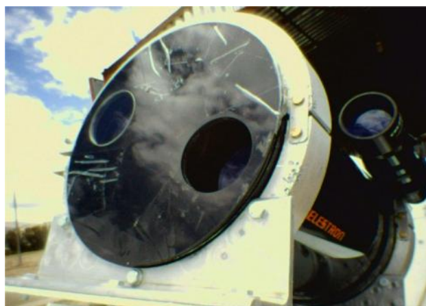
Fig. 2 Mascara con cuña óptica sobre el celestron 8.
