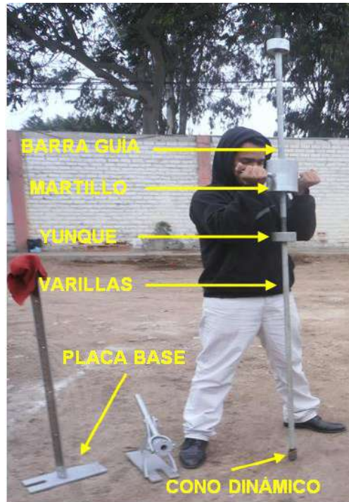
Figura 5: Equipos, accesorios y técnica de DPL
