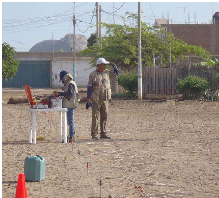
Figura 10: Disposición del equipo de prospección eléctrica en la ciudad de Mala
