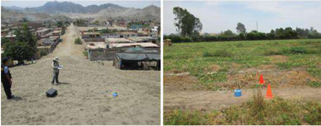
Figura 6: Equipo sísmico utilizado para el registro de vibraciones ambientales en la ciudad de Mala: sensores Lennartz (2N) y registrador CityShark
