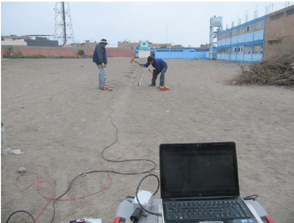
Figura 11: Imagen de la disposición del equipo de refracción sísmica
