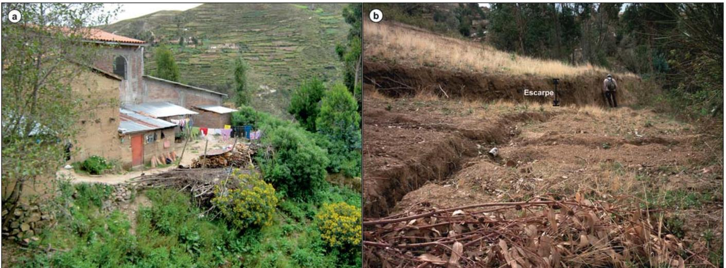
De izquierda a derecha: Foto 3.23 Se observa la parte posterior del local comunal y la parte lateral de una vivienda que se encuentra en una zona de alta pendiente. Foto 3.24 Se aprecia un escarpe de 0.5 a 1.5 metros de altura, el cual evidencia que el lugar es susceptible a deslizamientos; por tanto la C.C. Rangra presenta una alta vulnerabilidad física. Créditos L. Céspedes.
