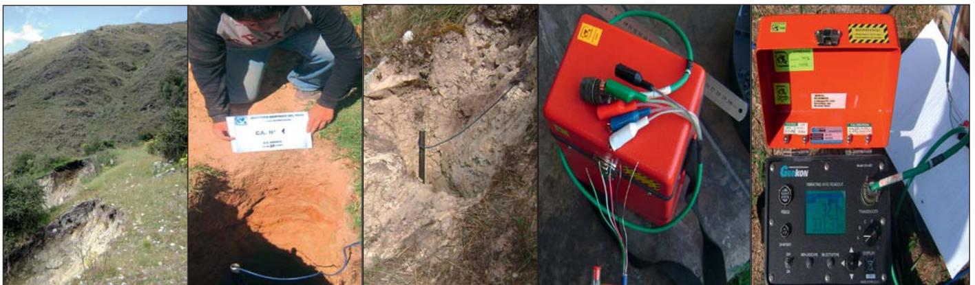
De izquierda a derecha: Foto 3.25 Localización del escarpe; Foto 3.26 Elaboración de la calicata; Foto 3.27 Instalación del piezómetro de hincado; Foto 3.28 Acoplamiento de los alambres del piezómetro con el cable transductor del lector de datos; y Foto 3.29 Toma de datos de la presión de poros mostrados en el lector de datos. Créditos M. Moreno.
