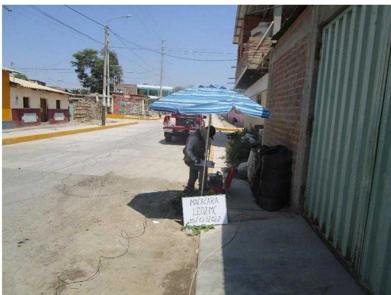
Figura 29. Disposición del equipo para la adquisición de datos de resistividad.
