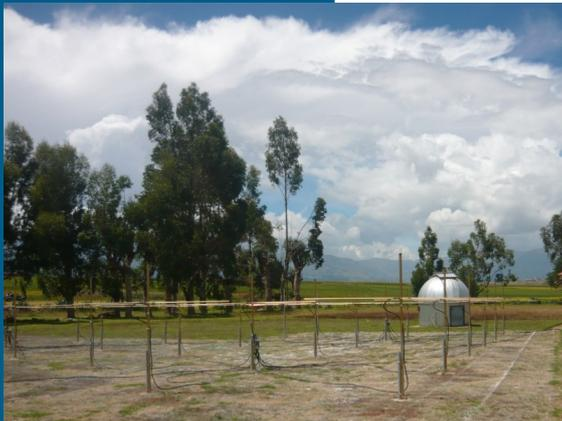
Vista parcial del radar BLTR, el cual está conformado por un arreglo de 27 dipolos.
