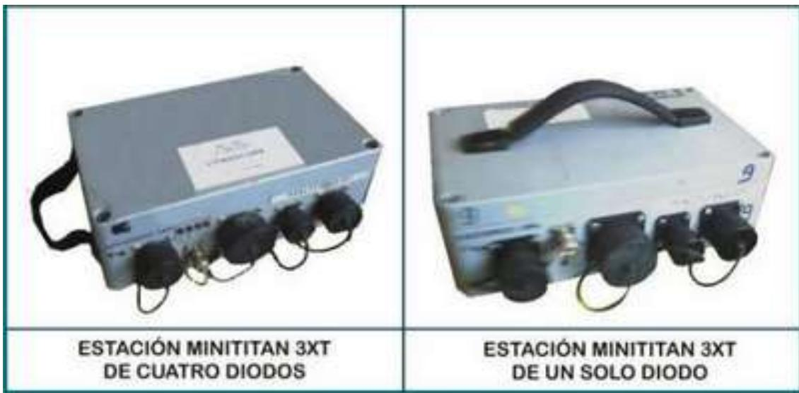
*Figura 4.2.- Estación sísmica MIniTitan 3XT de 1 y 4 diodos,*
