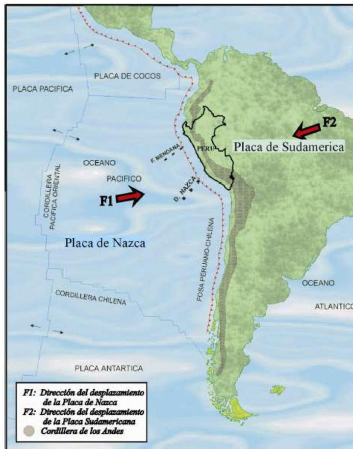
**Figura 2.2.-** Esquema del proceso de convergencia de la placa de Nazca (oceánica) y la Sudamericana (continental). F1 y F2 indica la dirección de desplazamiento de las placas según DeMets et al (1990). Las líneas discontinuas indican la ubicación y orientación de la Fractura de Mendaña y Dorsal de Nazca.
