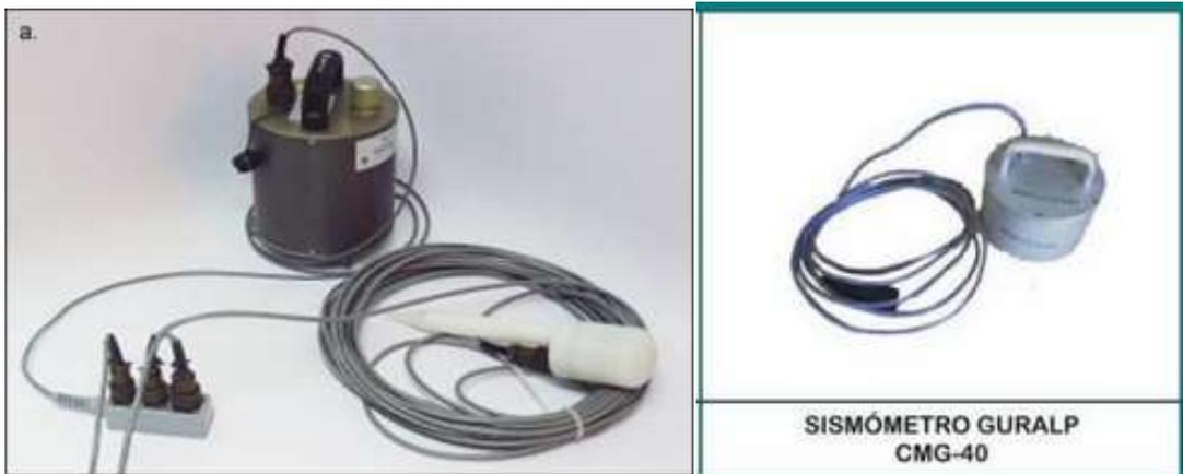
**Figura 4.3.-** Izquierda: Sensor sísmico Guralp 6TD, con GPS; Derecha: Sismómetro Guralp CMG-40.
