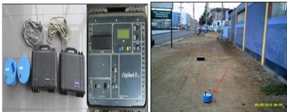
Figura 43: Equipo sísmico utilizado para el registro de vibraciones ambientales: sensores Lennartz y registradores CityShark
