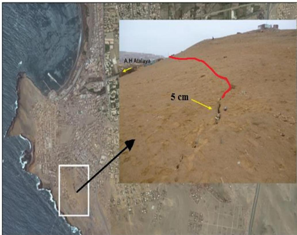
*Figura 18: Evidencias del fracturamiento del terreno en el A.H. Atalaya debido al asentamiento del mismo.*
