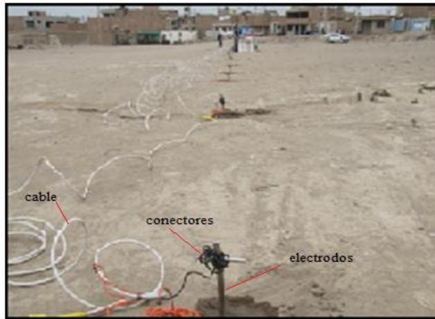
Figura 62: Equipo de campo requerido para la adquisición de datos de resistividad
