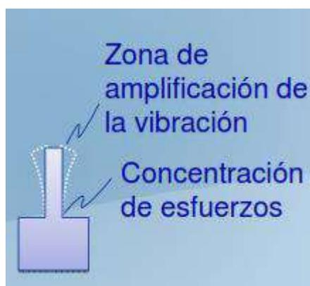
Figura N° 20. Comportamiento de una estructura ante un probable evento sísmico (Cuté, 2014).
