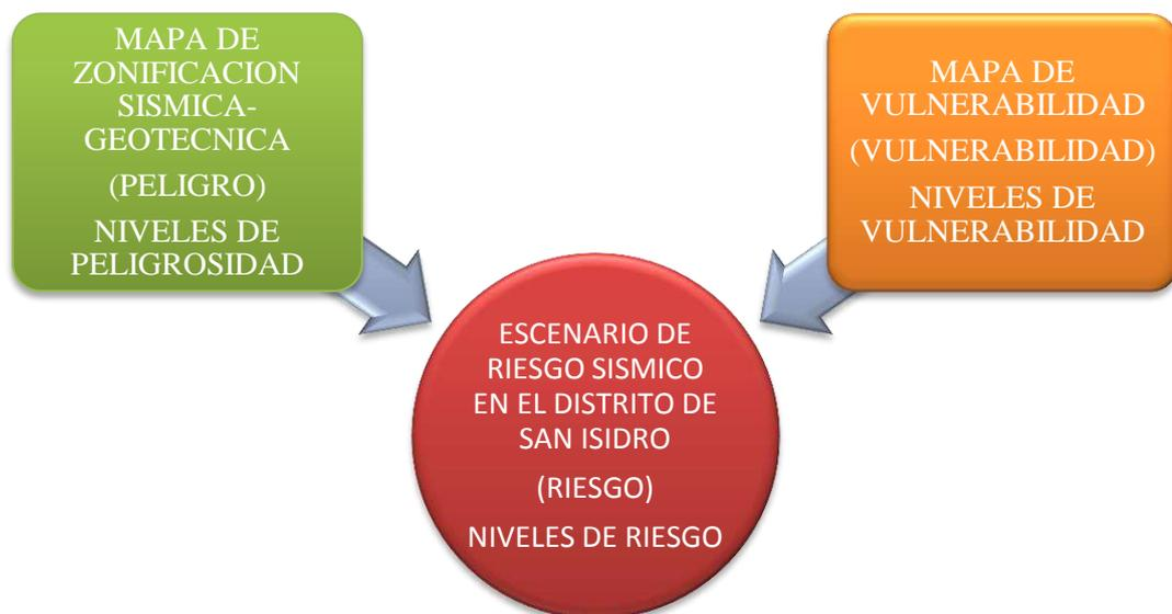
Figura N° 19. Flujograma para determinar el Escenario de Riesgo Sísmico en las Edificaciones en el distrito (CENEPRED, 2015).
