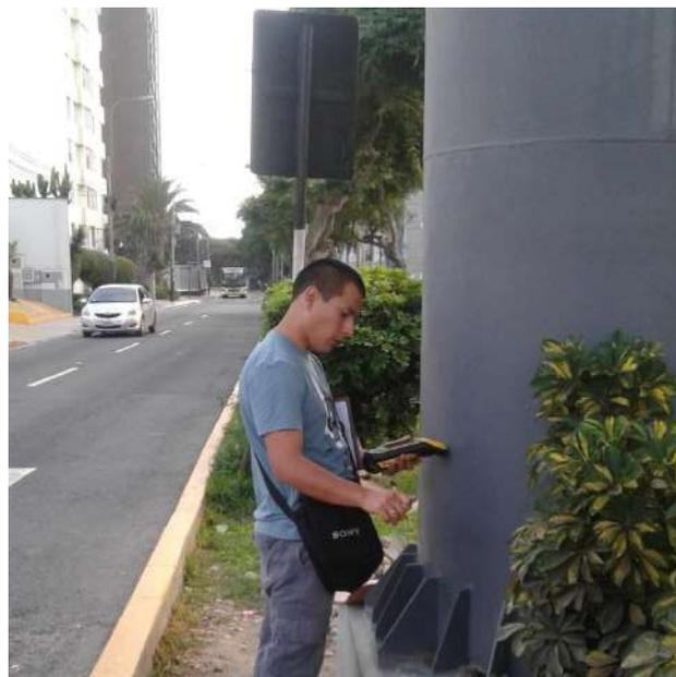
Fotografía N° 7. Levantamiento de campo con equipo GNSS Submetrico de panel monumental ubicado en el cruce la Av. Faustino Sánchez Carrión (Ex - Pershing) con Av. Juan de Aliaga.
