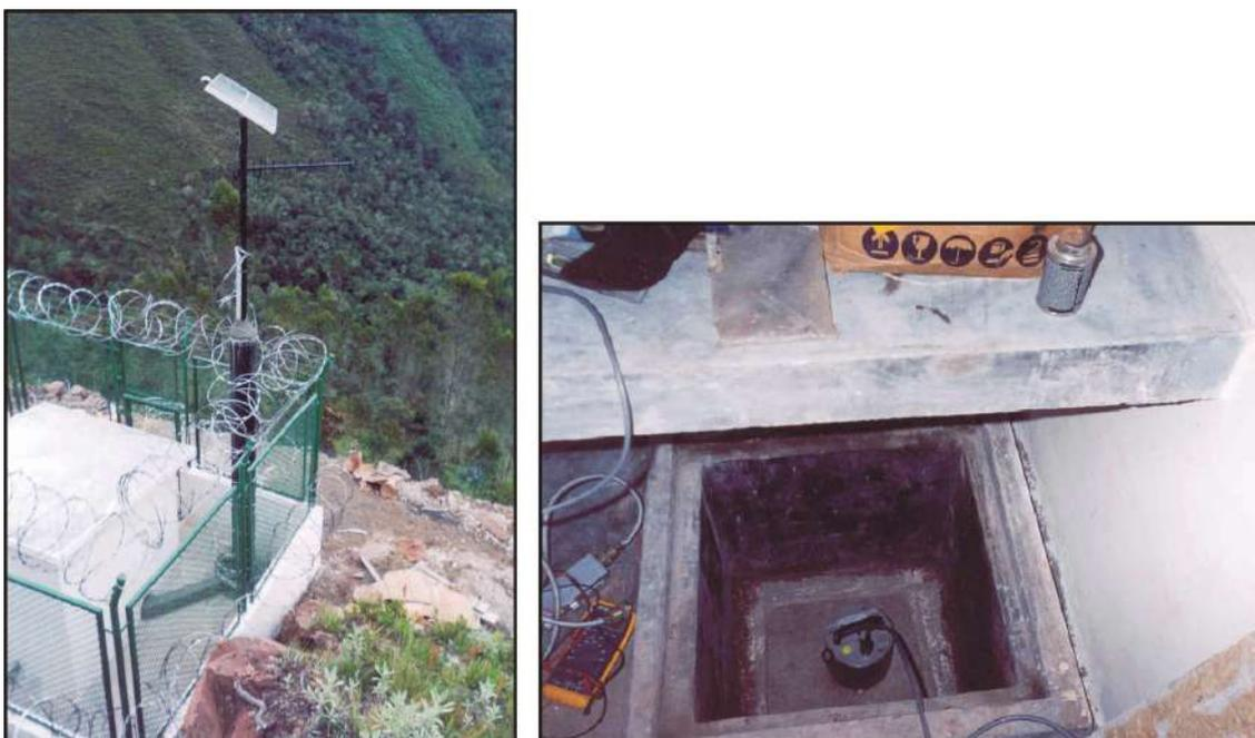
*Figura 7.7.1 Ubicación de la estación Chachapoyas (CHA). Obsérvese que el sensor se encuentra en un pequeño pozo, así como el tipo de suelo en la estación.*
