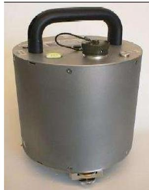
*Figura 2.7. Sismómetro 40-T Banda Ancha*
