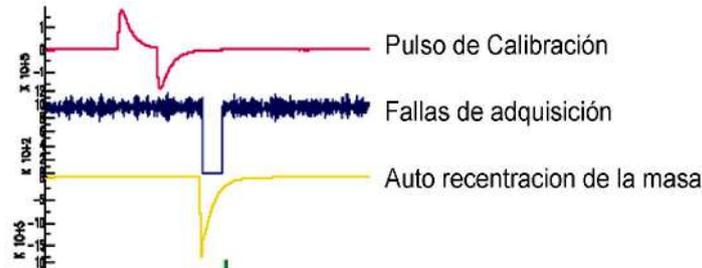
Figura 5.8 Muestra los diferentes tipos de ruidos instrumentales de baja probabilidad de ocurrencia (McNamara y Buland 2003).
