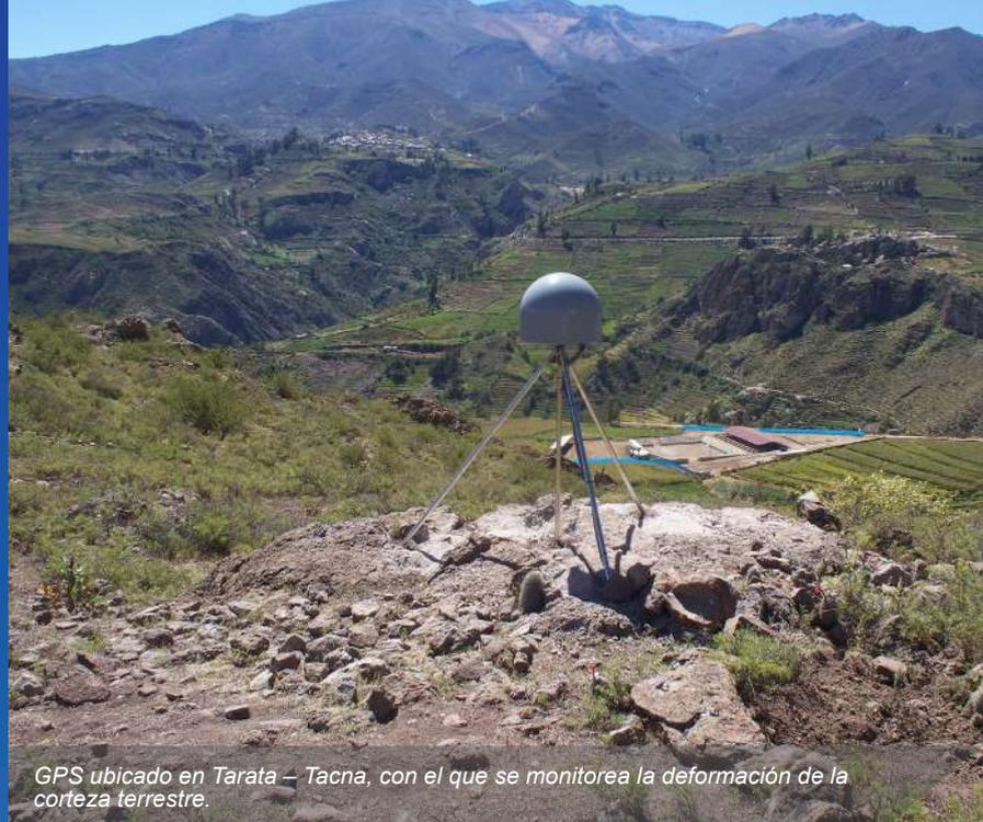
GPS ubicado en Tarata – Tacna, con el que se monitorea la deformación de la corteza terrestre.
